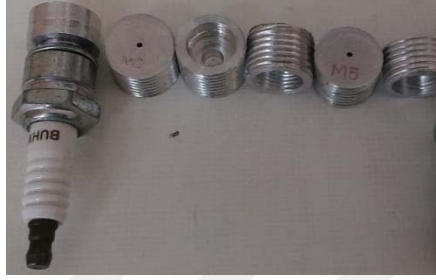
Şekil 2.2. Üretilmiş farklı ölçülere sahip BPSJ aktüatörün başlıkları
