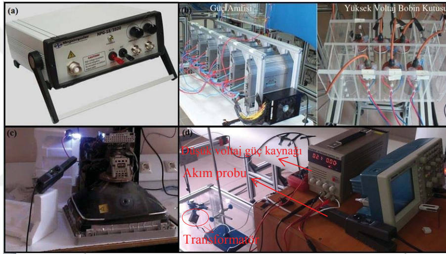
Fotoğraf 3.2. Nanopuls DA yüksek voltaj (a), audio güç amfisi ve bobinden (b) oluşan (Şanlısoy, 2013), tüplü monitör (c) ve transformatörlü (d) güç kaynağı
