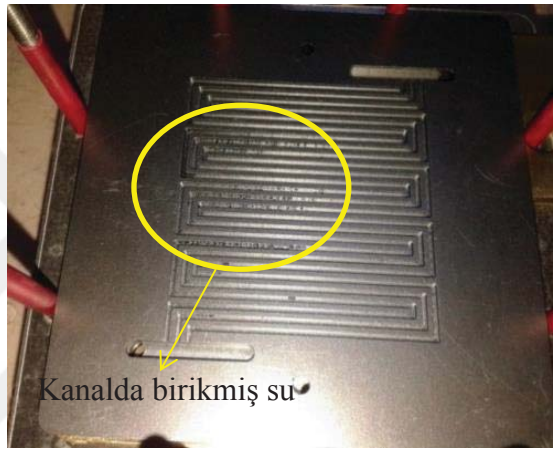
Fotoğraf 3.7. Yakıt pili akış kanalında oluşan su birikimi
