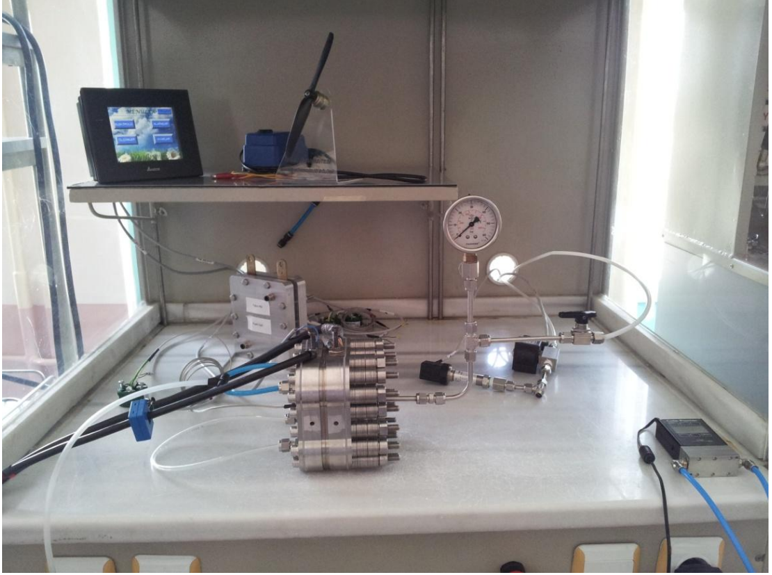
Fotoğraf 3.4. Deneilerde kullanılan tek hücreli EHK
