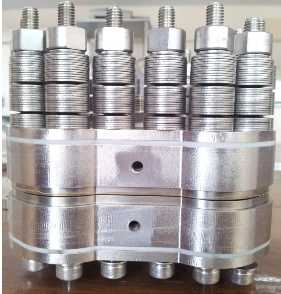
Fotoğraf 3.1. İmalatı yapılan EHK bileşenlerinin montaj hali
