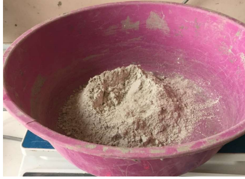
Fotoğraf 6.2. Öğütülmüş granüle yüksek fırın cürufunun görünümü
