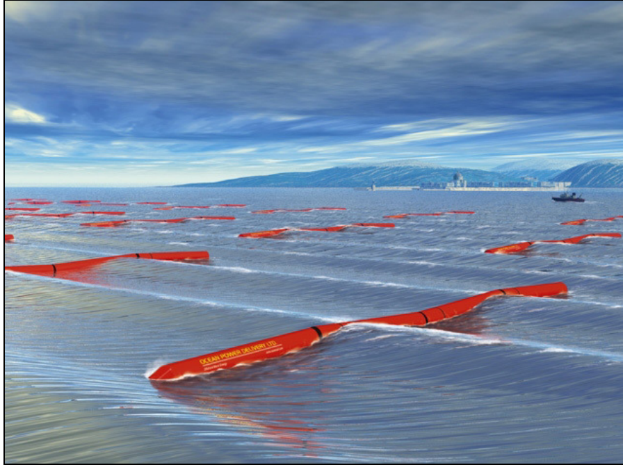
Şekil 2.9. Dalgadan enerji üreten pelamis ( deniz yılanı )
