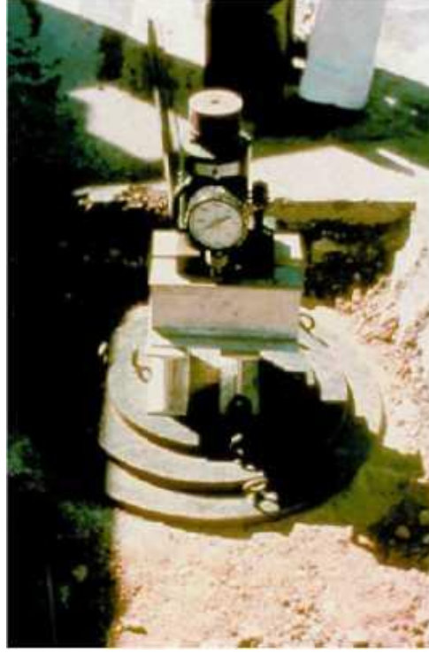
Fotoğraf 3.2. Plaka yükleme testi deney aleti uygulama
