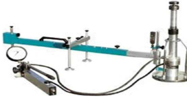
Fotoğraf 3.1. Plaka yükleme testi deney aleti
