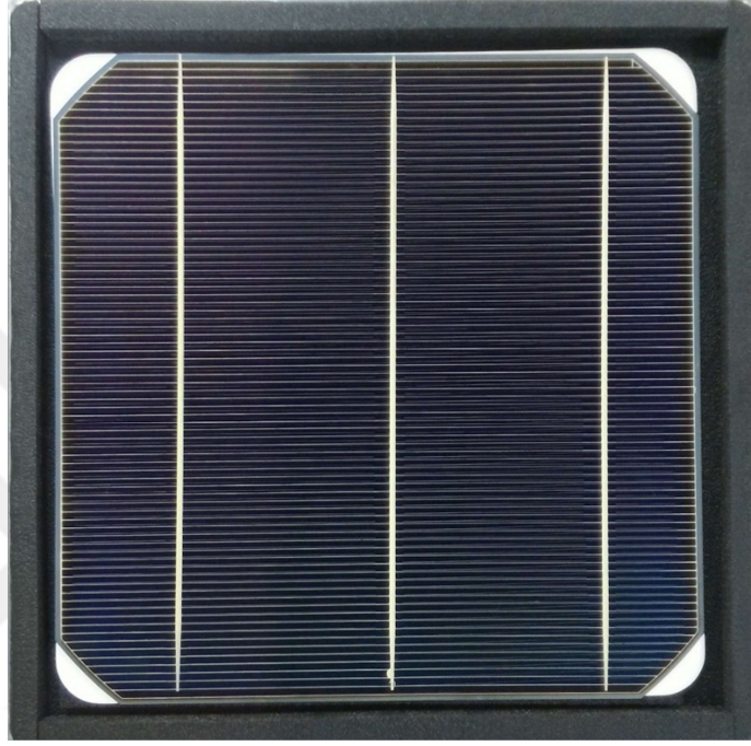
Fotoğraf 5.9. 3 Busbarlı ve 87 adet fingerlı dizaynının uygulandığı hücre
