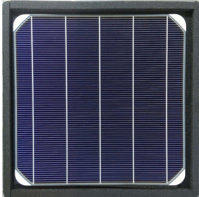
Fotoğraf 5.10. 5 Busbarlı ve 75 adet fingerlı dizaynının uygulandığı hücre
