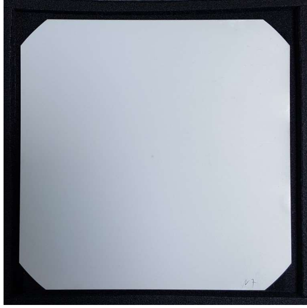
Fotoğraf 5.3. PVD ile arka yüzeyi tamamen gümüş kaplanmış hücre
