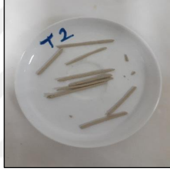
Fotoğraf 5.2. Plastik limit deney numunesi
