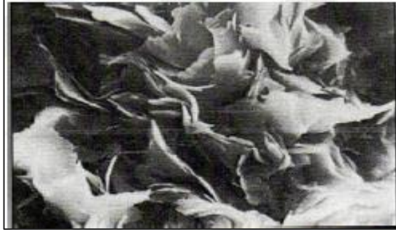
Şekil 2.10. Klorit kil mineralinin örnek bir SEM görüntüsü (Aydın, 2018)
