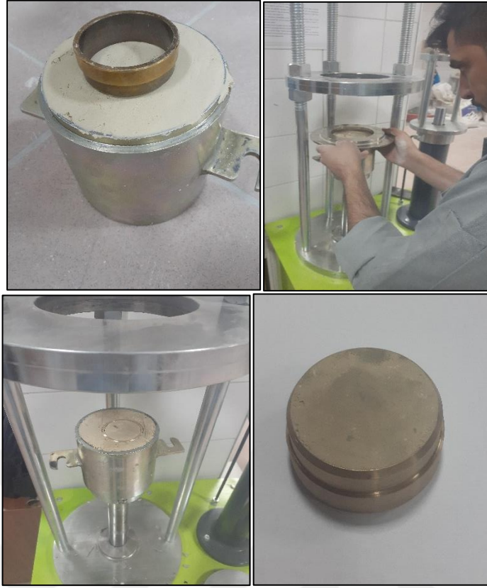
Fotoğraf 5.5. Konsolidasyon deney numunesinin hazırlanması
