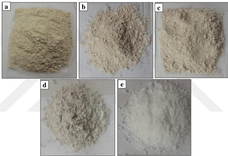
Fotoęraf 5.7. Deney malzemeleri; Na bentonit (a), kaolen (b), doęal zemin (c), YFC (d) ve nano-SiO 2 (e)
