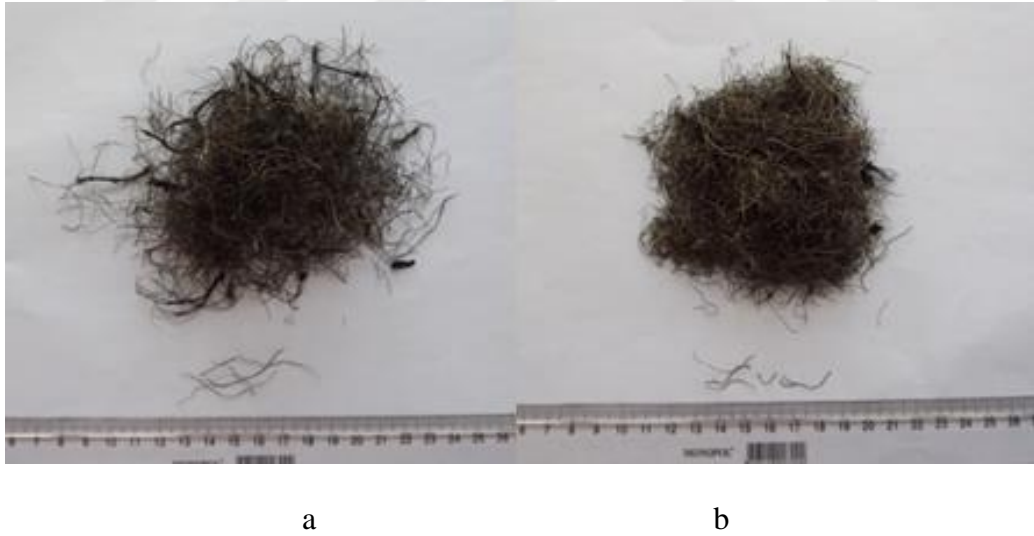
Fotoğraf 4.2. Uzun atık tel (a) ve kısa atık tel (b) görünümü
