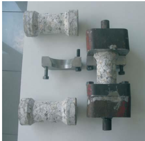
Fotoğraf 3.2. Çelik lifli betonun direk çekme dayanımı deneyi
