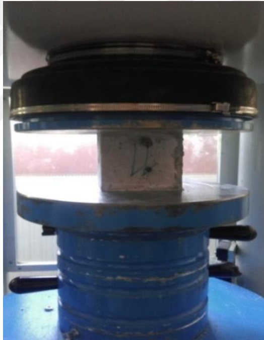
Fotoğraf 4.4. Beton basınç dayanımı deney düzeneği
