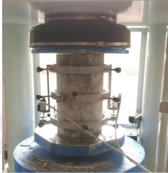
Fotoğraf 4.7. Elastisite modülü deney düzeneği
