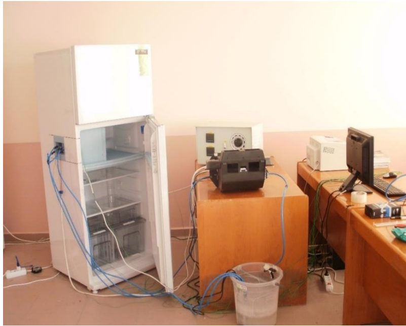
Fotoğraf 3.7. Arçelik 5223 ev tipi buzdolabı ile oluşturulan deney seti
