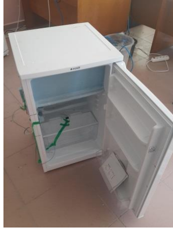
Fotoğraf 3.6. Arçelik 1050 büro tipi buzdolabı ile oluşturulan deney seti
