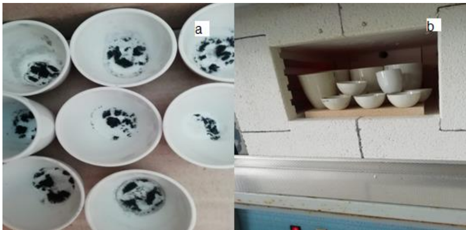
Fotoğraf 3.5. Krozelerde arı sütü külü (a) ve 550 derecede arı sütlerinin kül fırınında yakılması (b)
