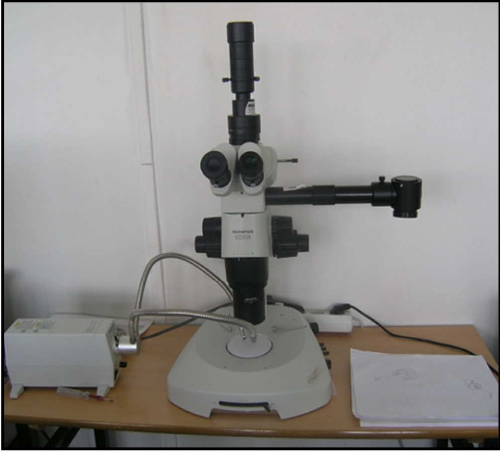
Fotoğraf 2.4. Fotoğraflama işlemlerinde kullanılan SZX16 stereomikroskop
