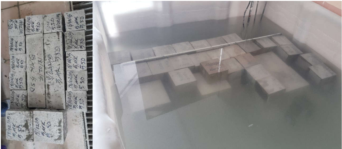
Fotoğraf 3.5. İsimlendirilmiş ve kür uygulanan beton örnekleri
