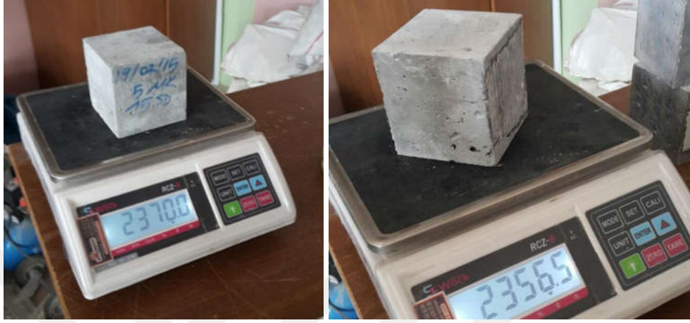
Fotoğraf 3.6. Sertleşmiş beton birim ağırlık deneyi
