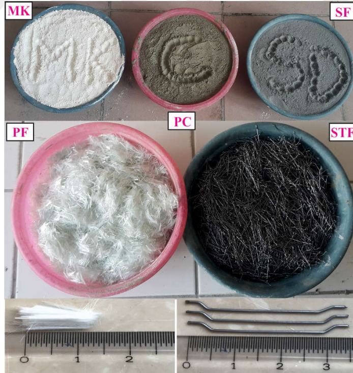
MK= Metakaolin, PC=Portland Çimento, SF=Silis Dumanı, PF= Polipropilen fiber, STF=Çelik Fiber
