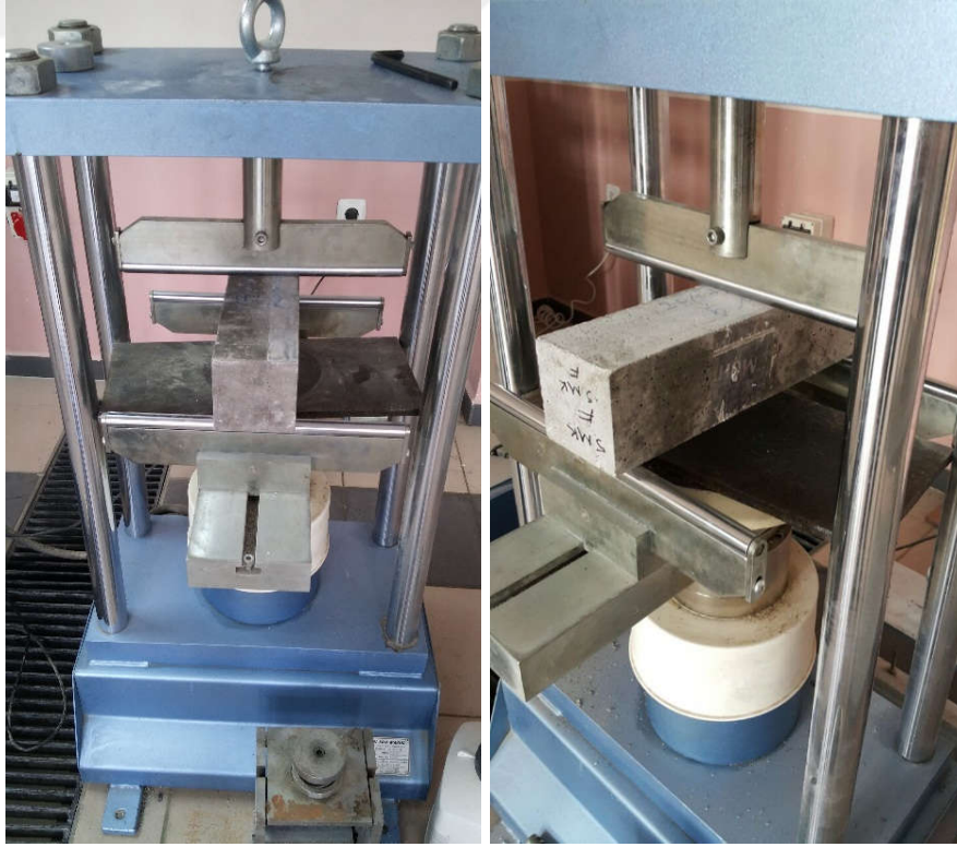
Fotoğraf 3.11. Beton üzerinde f_{fs} deneyinin yapılışı
