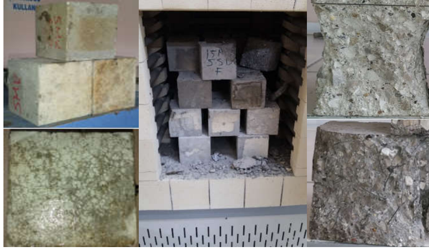
Fotoğraf 3.12. Yüksek sıcaklık etkisine maruz kalan MK ve MK+SD serisi betonlar
