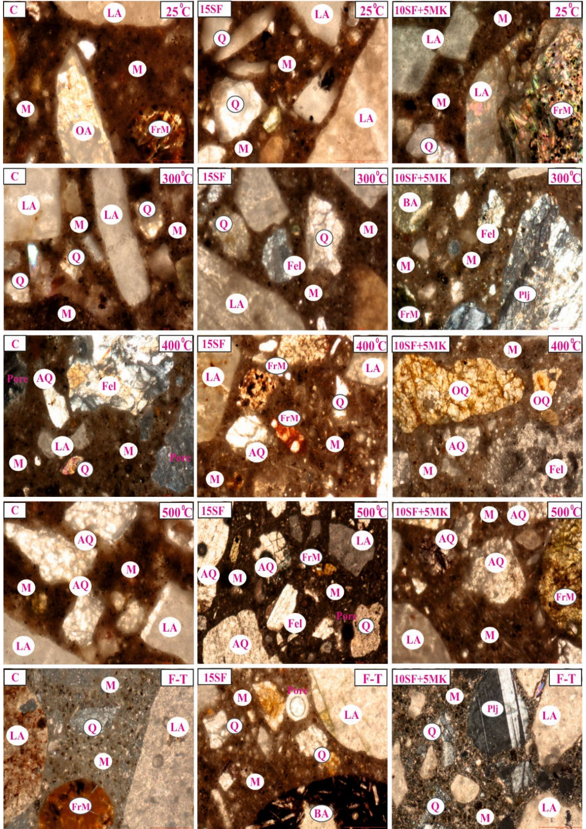
M: Matris, Q: Kuartz, LA: Kalker agregası, BA: Bazalt agregası, Bi: Biotit, FrM: Ferromagnezyum, Pij: Plajiyoklaz, OM: Okstilenmiş matris, OA: Oksitlenmiş agregası, AQ: Değişmiş kuartz
