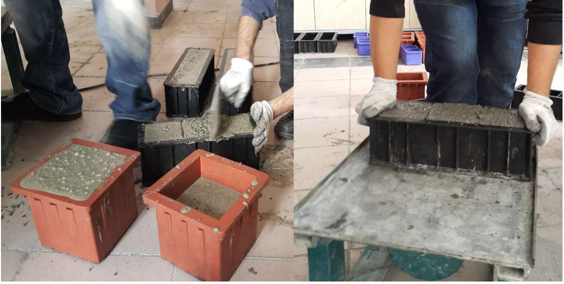
Fotoğraf 3.3. Taze betonun kalıplara yerleştirilmesi ve sıkıştırılması
