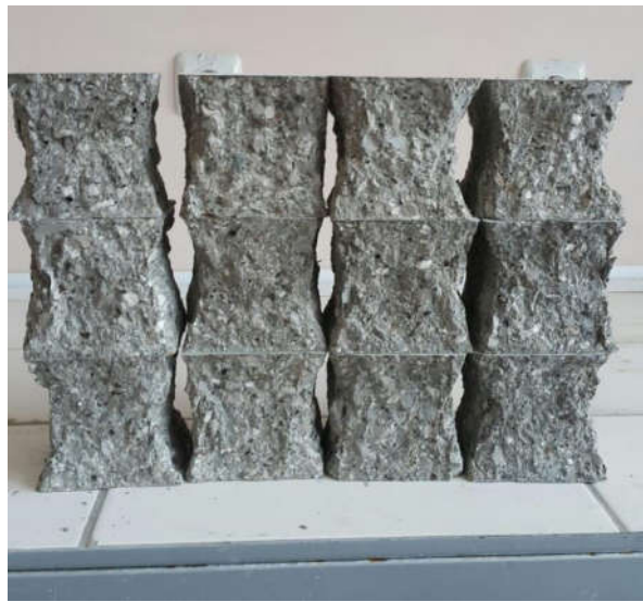
Fotoğraf 3.9. f_c deneyi sonucunda kırılmış numune örnekleri
