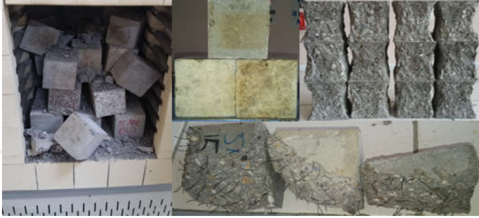
Fotoğraf 3.13. Yüksek sıcaklık etkisine maruz kalan SD ve SD+MK serisi betonlar
