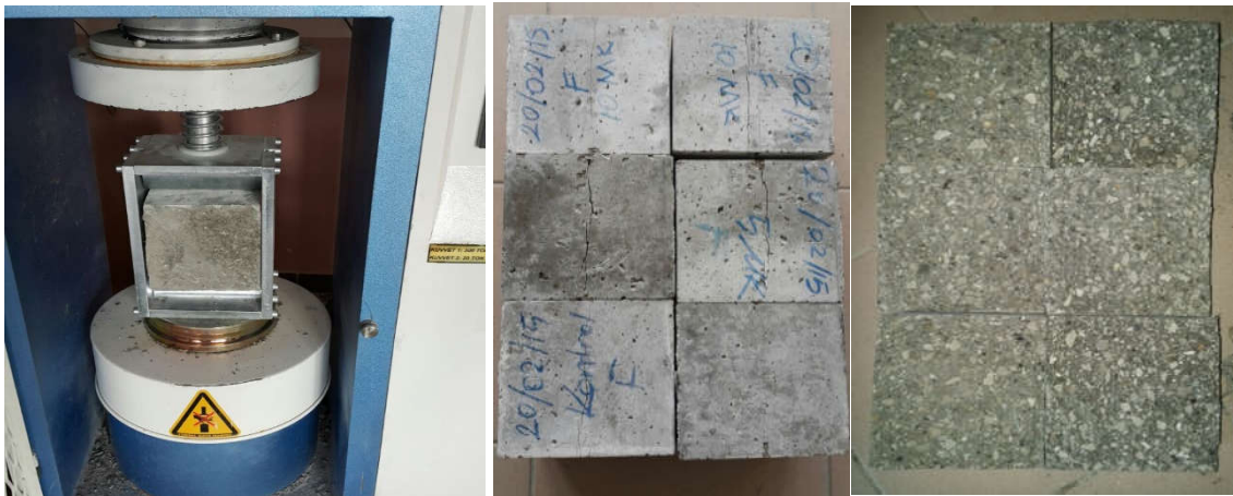
Fotoğraf 3.10. Beton üzerinde f_{sts} deneyinin yapılışı ve kırılmış numuneler
