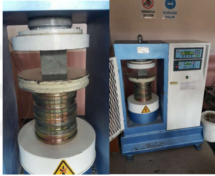
Fotoğraf 3.8. Beton üzerinde f_c deneyinin yapılışı
