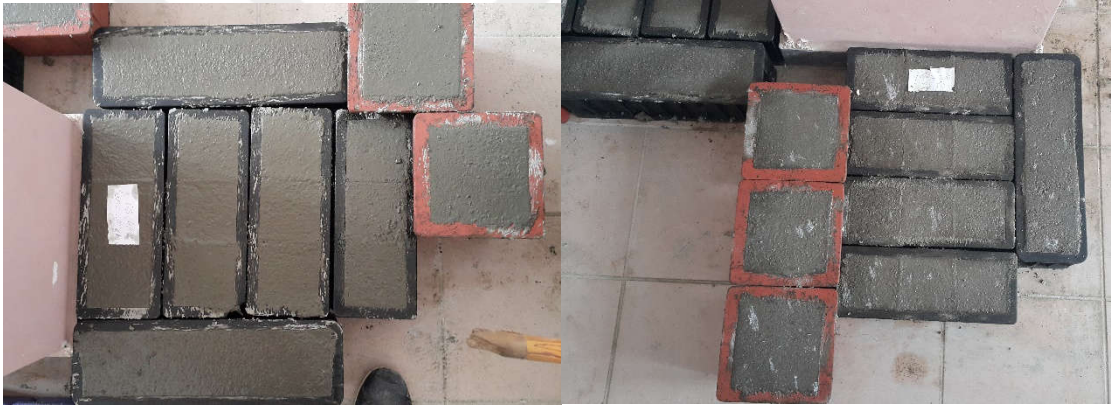
Fotoğraf 3.4. Kalıplara yerleştirilmiş taze ve sertleşmiş beton
