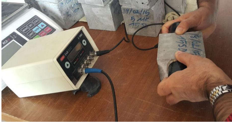
Fotoğraf 3.7. Beton üzerinde U_{pv} deneyinin yapılışı
