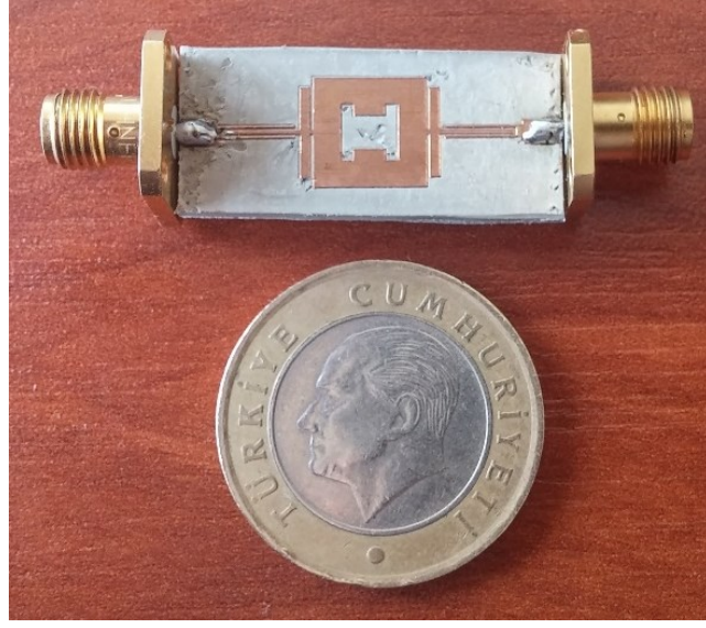
Fotoğraf 5.4. İmal edilen yedinci dereceden ÇGB BGF
