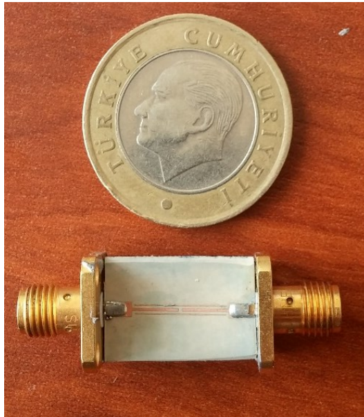
Fotoğraf 5.1. İmal edilen üçüncü dereceden GB BGF ve frekans cevabı
