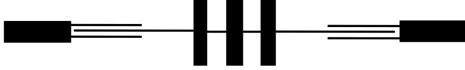
Şekil 1.9. EBG yapısı kullanılarak oluşturulmuş ÇMR konfigürasyonu
