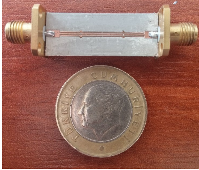
Fotoğraf 5.2. İmal edilen beşinci dereceden GB BGF ve frekans cevabı
