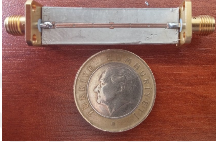
Fotoğraf 5.3. İmal edilen yedinci dereceden GB BGF ve frekans cevabı
