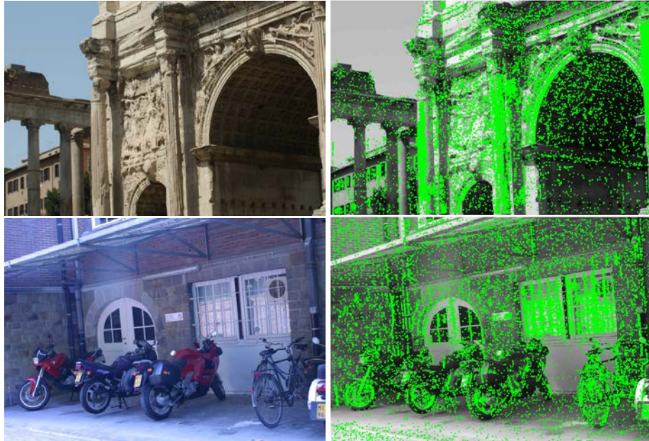
Şekil 5.5. TPDK ile bulunan örnek öznitelik noktaları
