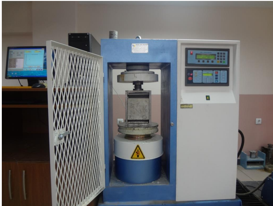
Fotoğraf 4.9. Yarmada çekme dayanımı deney düzeneği
