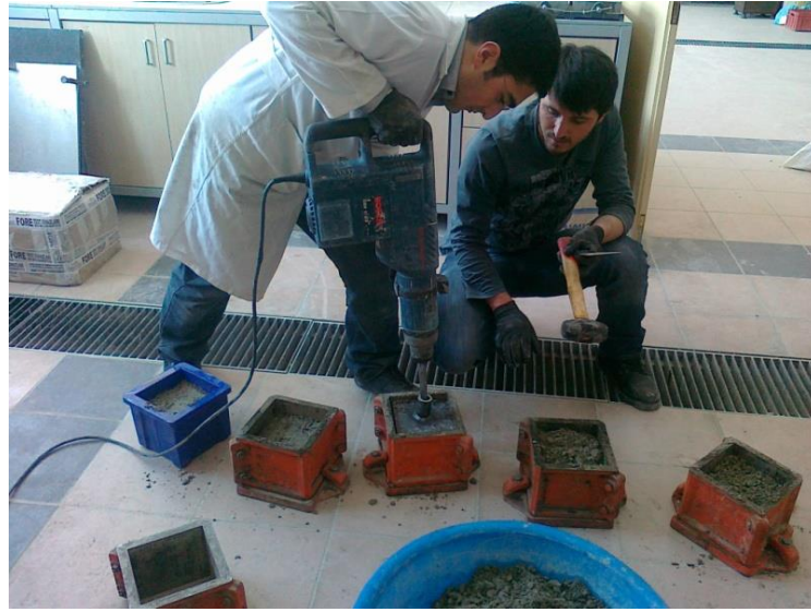
Fotoğraf 4.3. 15 cm ebatlı küp numunenin sıkıştırma işlemi
