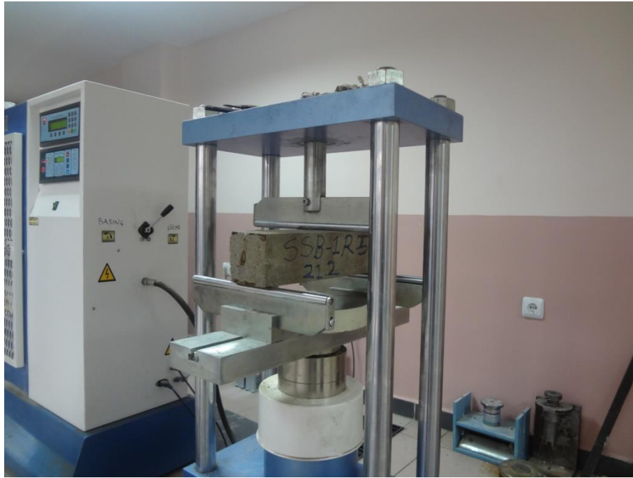
Fotoğraf 4.8. Eğilmede çekme dayanımı deney düzeneği
