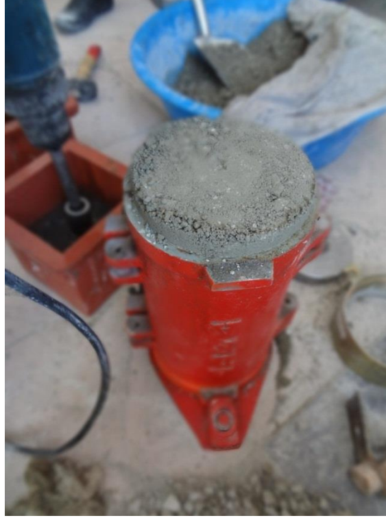
Fotoğraf 4.5. Silindir numunenin sıkıştırma işlemi
