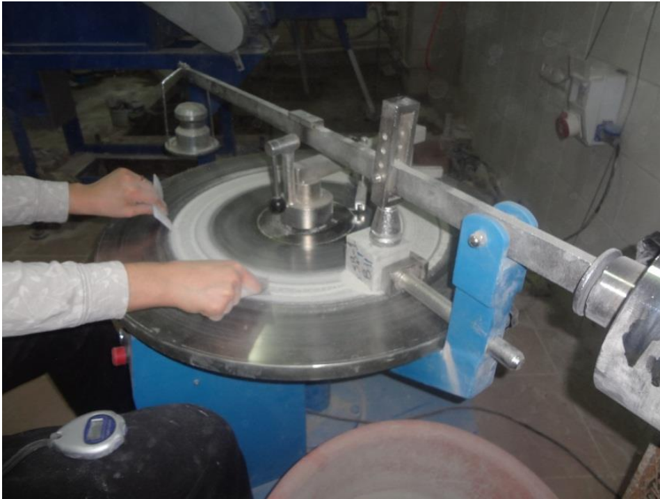
Fotoğraf 4.11. Böhme aşınma deneyi yapılması
