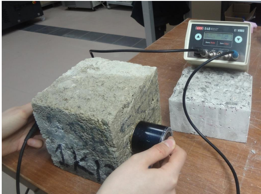
Fotoğraf 4.7. Numunelerin ultrases geçiş hızının belirlenmesi
