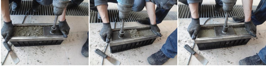
Fotoğraf 4.4. Kiriş numunenin sıkıştırma işlemi
