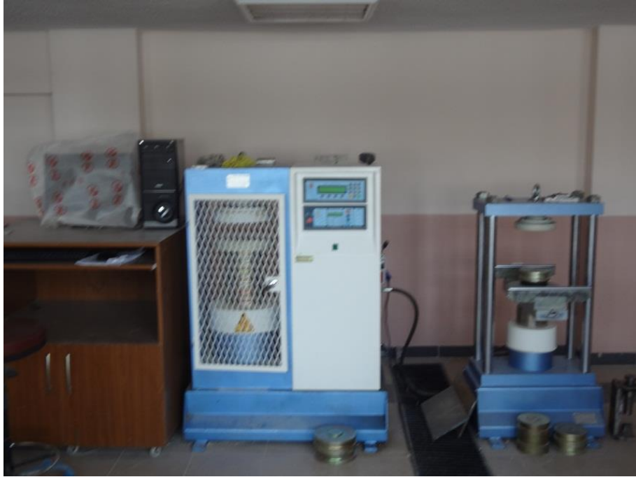
Fotoğraf 4.6. Numunelerin basınç dayanımı test aleti
