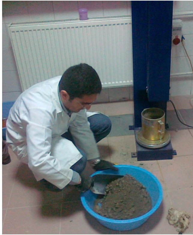
Fotoğraf 4.2. SSB'ların modifiye proktor deneyi yapılarak maksimum kuru birim ağırlığının belirlenmesi
