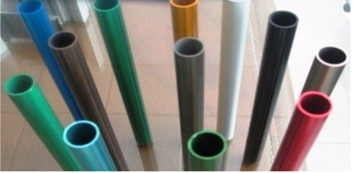
Fotoğraf 2.16. Elektrostatik toz boya uygulanmış boru profiller
