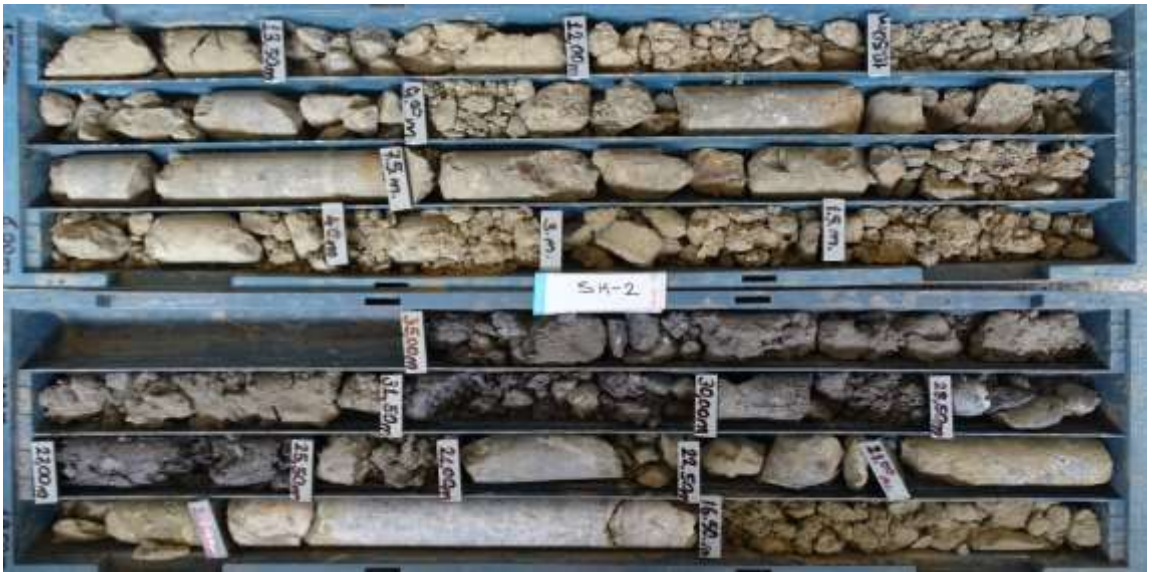
Şekil 4.34. SK-2 nolu sondajın karot sandık görüntüsü
