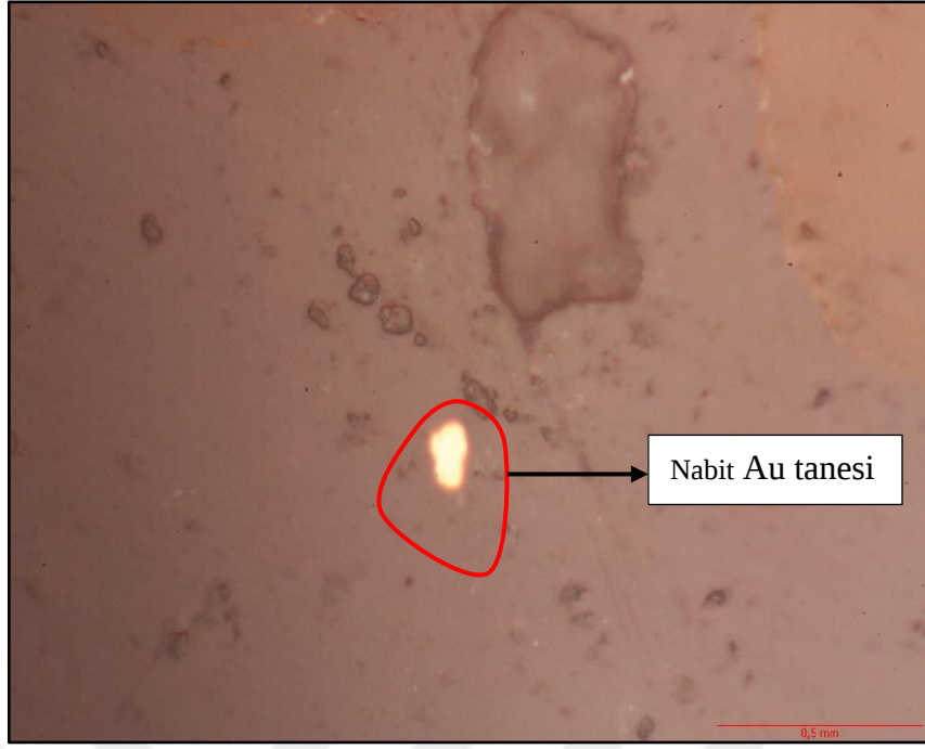
Fotoğraf 5.20. Taneleri 70 \mu\text{m} boyutuna ulaşan nabit Au tanesinden bir görüntü
