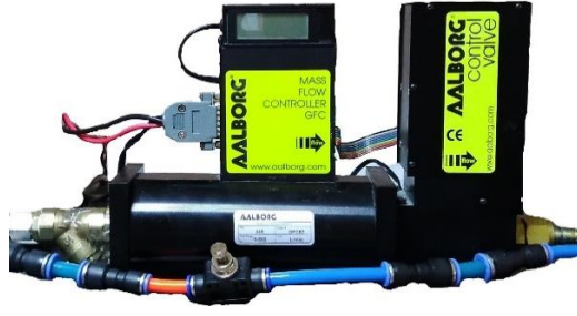
Fotoğraf 2.8. AALBORG marka CFC67model kütleli debi ölçer
