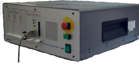
Fotoğraf 2.7. Traverse mekanizmasının kontrol ünitesi
