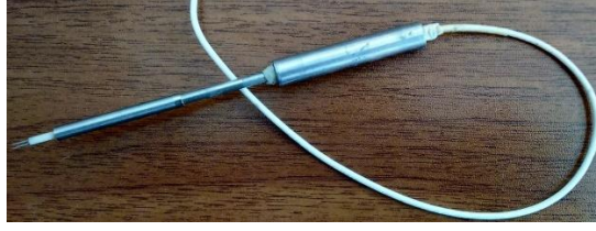
Fotoğraf 2.4. 55P16 model kendinden kablolu kızgın-tel anemometresi probu
