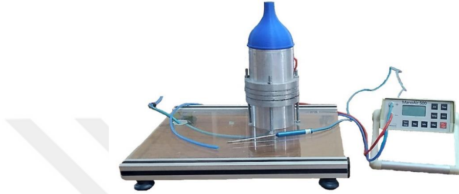
Fotoğraf 2.5. Lüle tipi kalibratör ve MonoAir 500 mikro manometre
