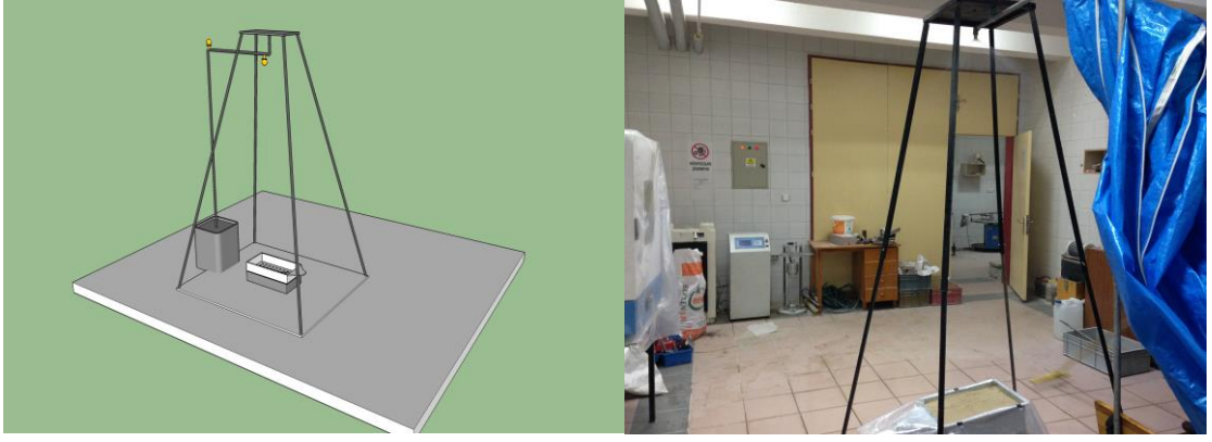
Fotoğraf 4.2. Labovatuvar uygulamalarında yapay yağmurlayıcı
