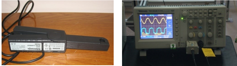
Fotoğraf 2. 9. Elektrodaki akım sinyalinin akım probu ile ölçülmesi
