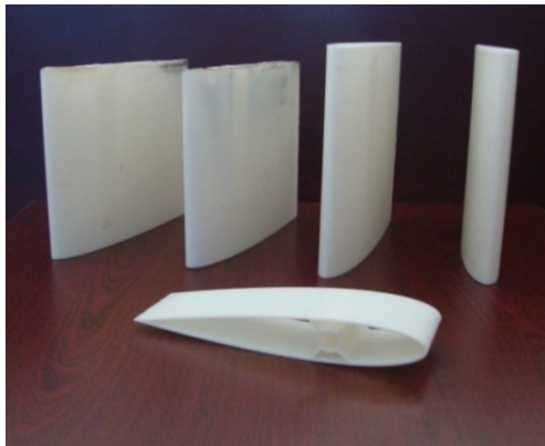
Fotoğraf 2. 6. NACA0015 model uçak kanadının parça ve montaj resimleri (Akansu ve Karakaya, 2013).
