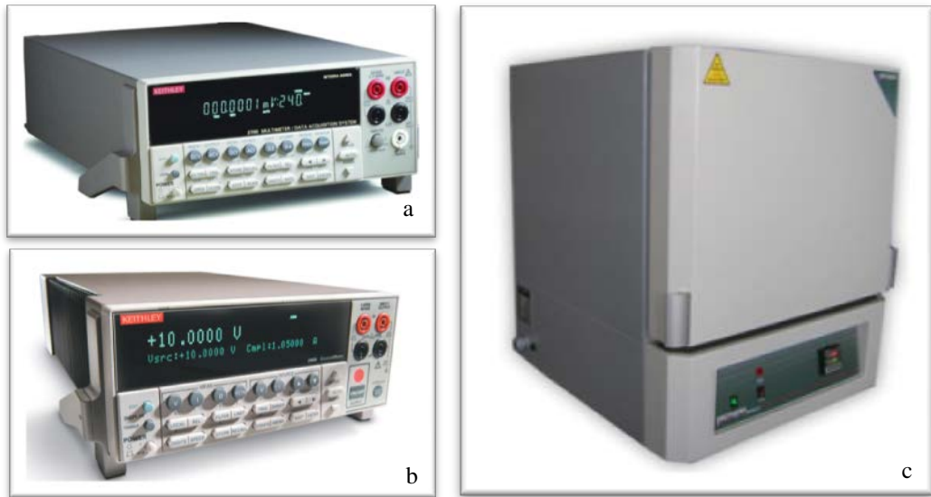
Şekil 3. 29. a) Keithley 2700 marka multimetre b) Keithley 2400 marka programlanabilir güç kaynağı c) Protherm marka kül fırını
