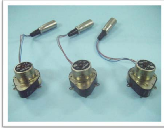
Şekil 3.18. Numunelerin farklı hızlarda katılaştırılmasını sağlayan senkronize motorlar
