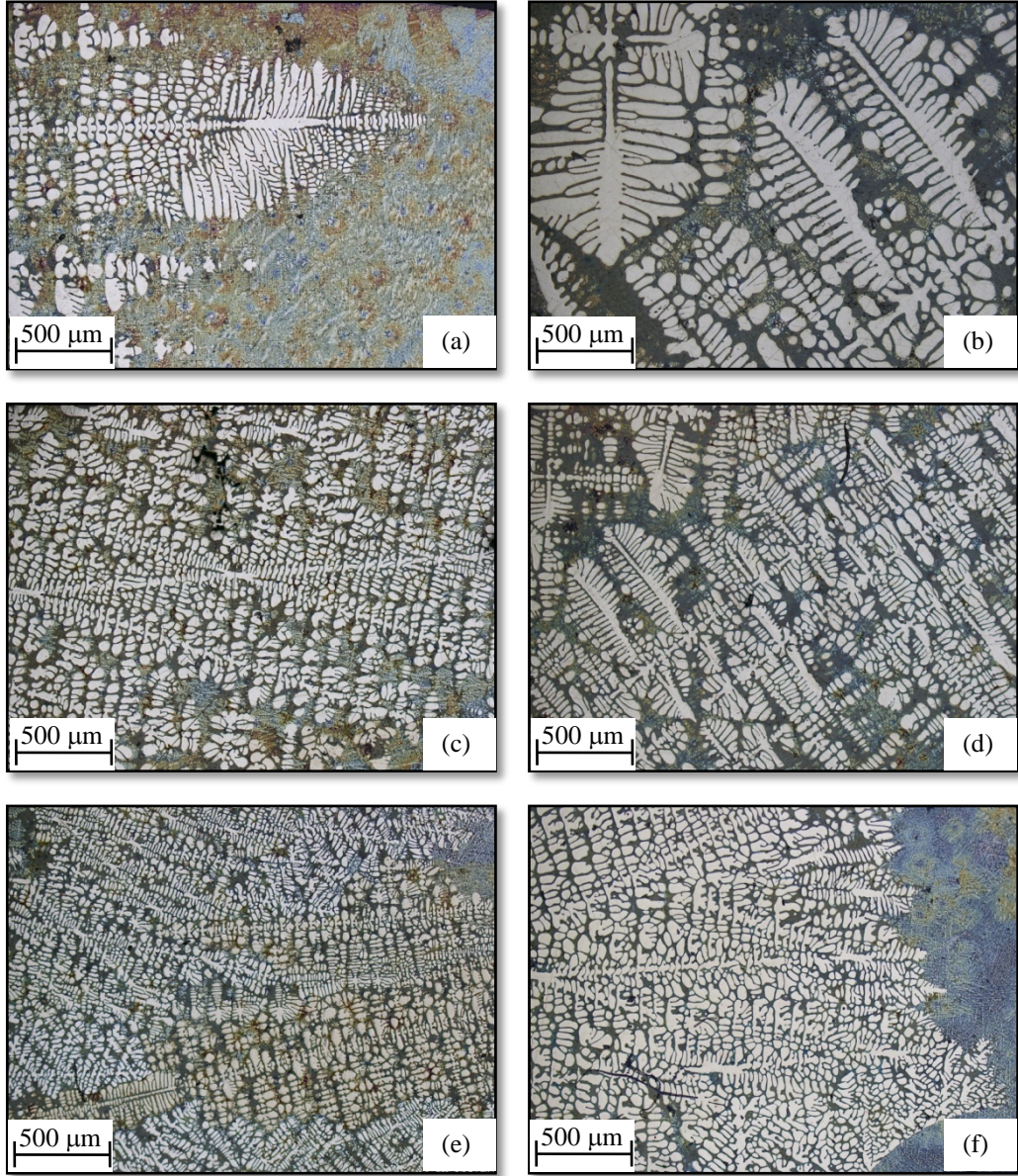
Şekil 4.4. Doğrusal katılaştırılmış Al-Cu-Si dendritik alaşımı için sabit sıcaklık gradyenti ( G=4.64 K/mm) farklı katılaştırma hızlarında ( V=8.3-83 \mu\text{m/s} ) oluşan mikroyapıların bazı optik mikroskop fotoğrafları
