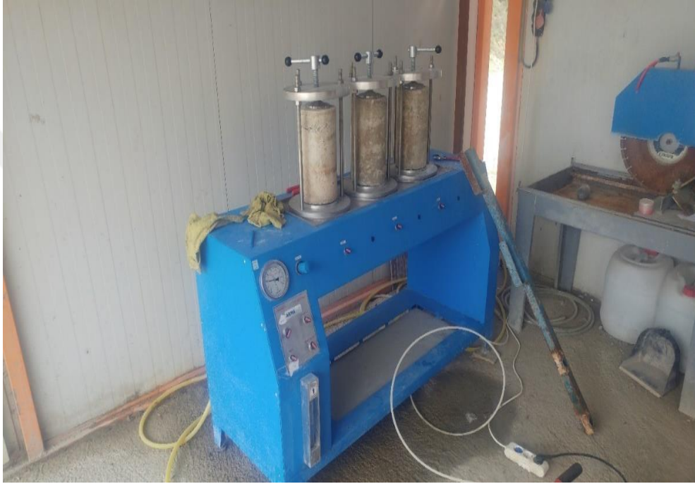
Fotođraf 4.8. SSB silindirik numunenin geçirgenlik deneyi testi
