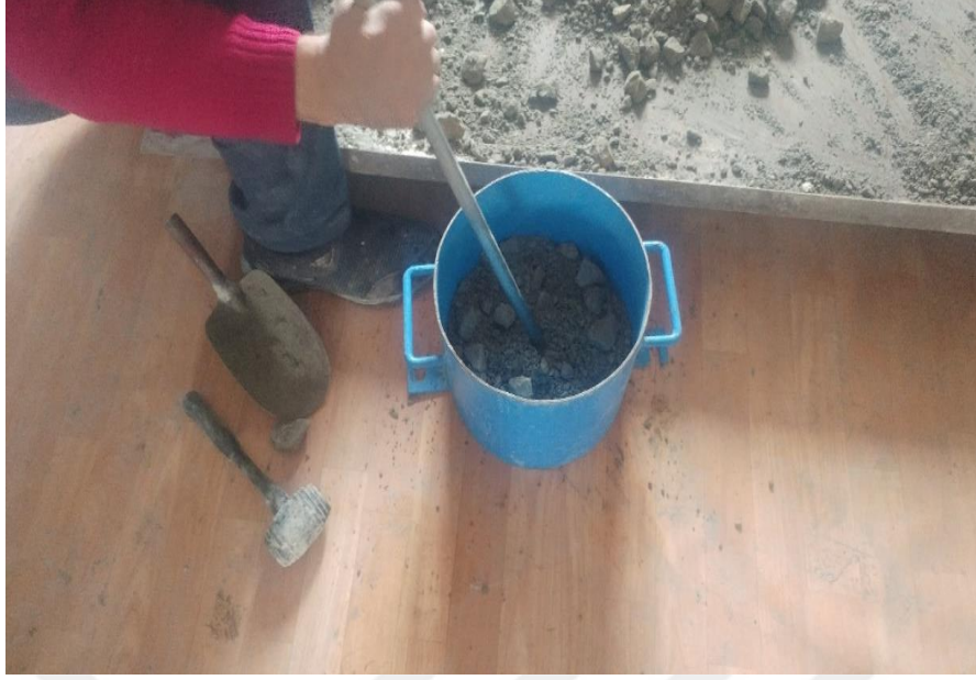
Fotoğraf 4.2. SSB'nin Vebe kalıbına yerleştirilmesi
