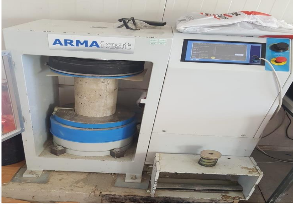
Fotoğraf 4.4. Silindirik numunenin aksel basınç dayanımı testi
