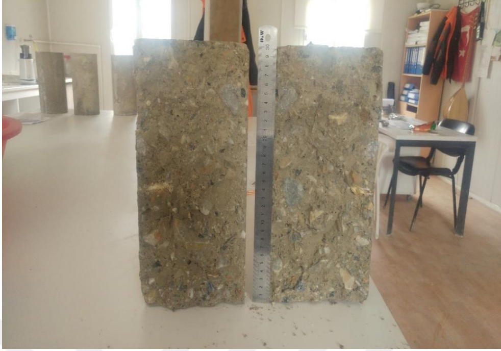
Fotoğraf 4.7. SSB numunenin su işleme derinliği
