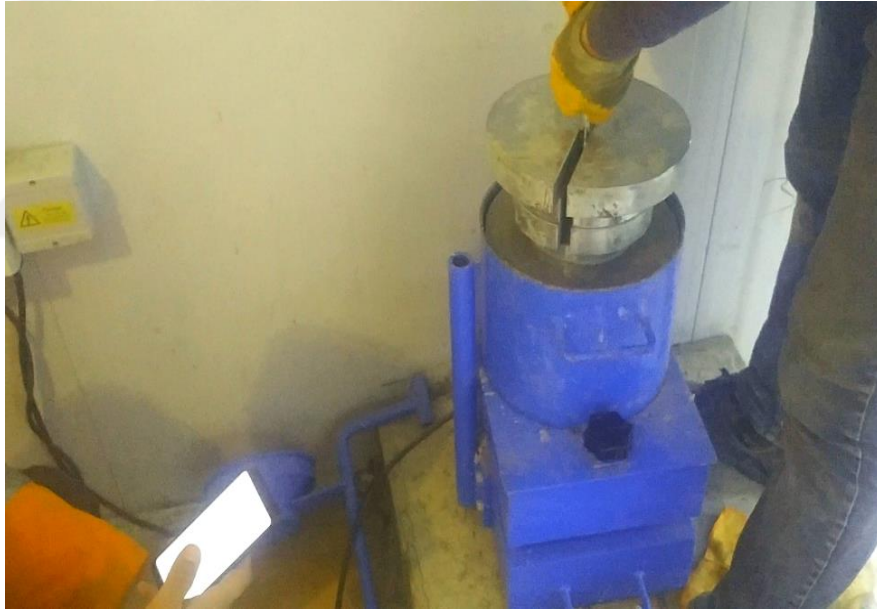
Fotoğraf 4.3. SSB karışımına Vebe deneyinin uygulanışı
