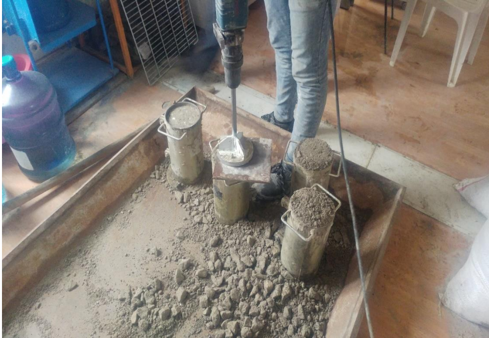
Fotoğraf 4.1. SSB'nin silindirik numune kaplarına sıkıştırılarak yerleştirilmesi
