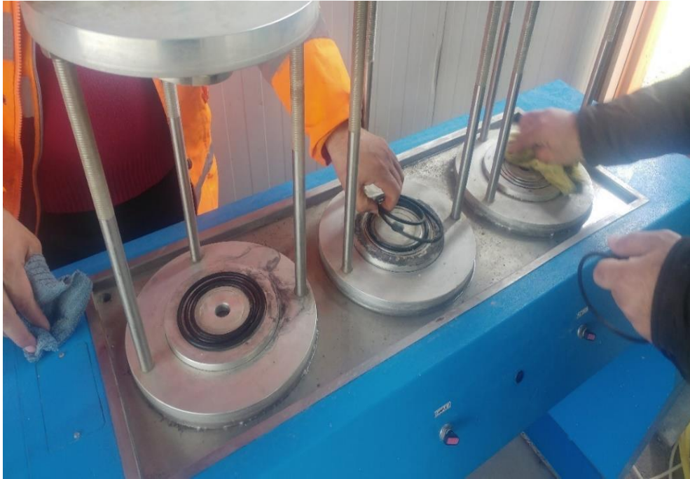
Fotoğraf 4.6. Su işleme derinliği ölçümü cihazı
