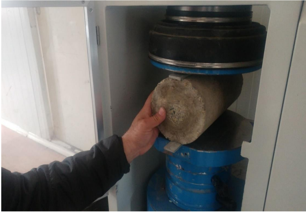
Fotoęraf 4.5. Silindirik numunenin yarmada çekme dayanımı testi
