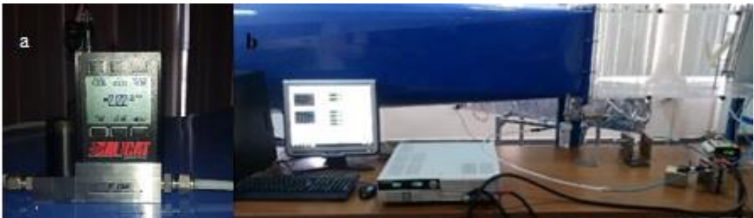
Fotoğraf 3.8. Debi kontrolörü (a) ve tüm düzenek (b) (Akansu vd., 2017)
