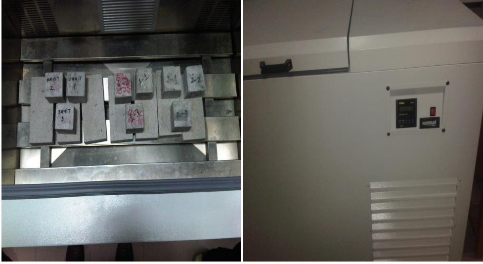
Fotoğraf 3.8. Donma çözülmeye maruz kalmış beton numuneler
