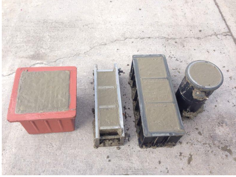
Fotoğraf 3.2. Taze betonların kalıplara yerleştirilmiş hali
