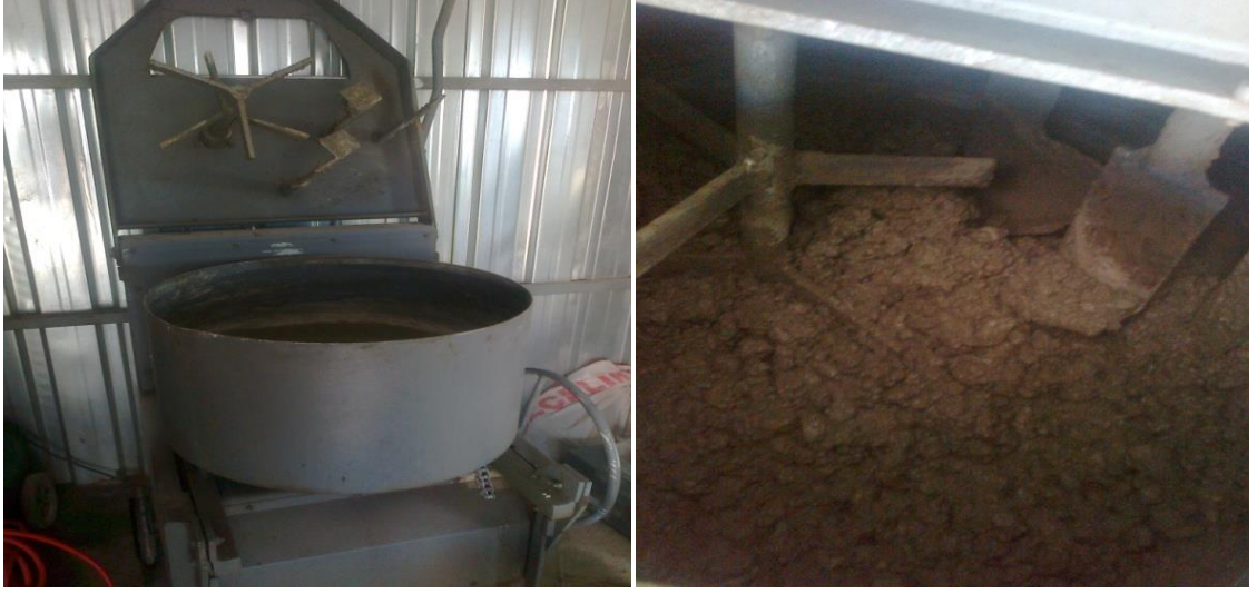
Fotoğraf 3.1. Taze betonun hazırlanması
