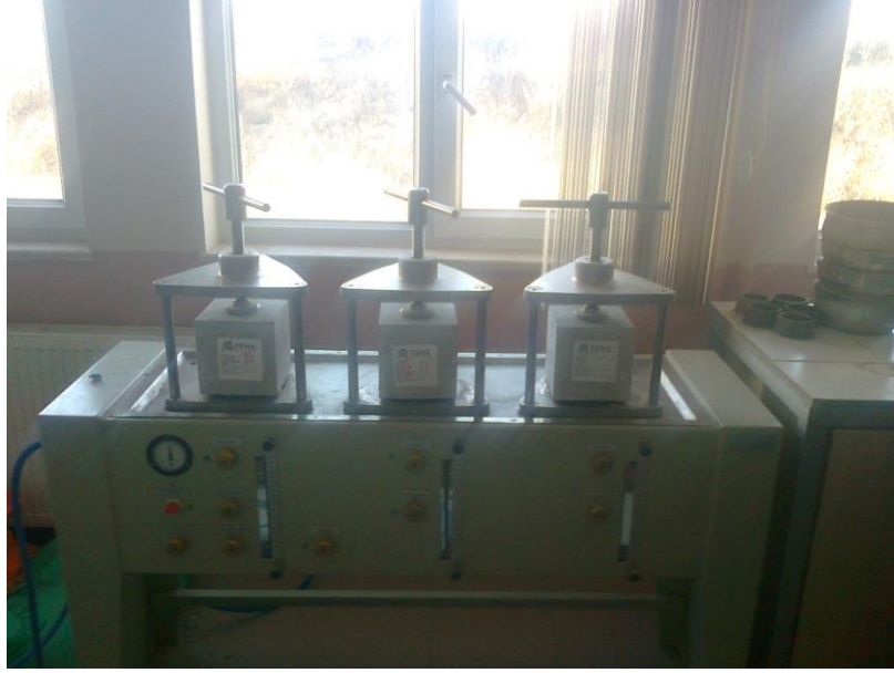
Fotoğraf 3.10. Betonda basınç altında su işleme derinliği
