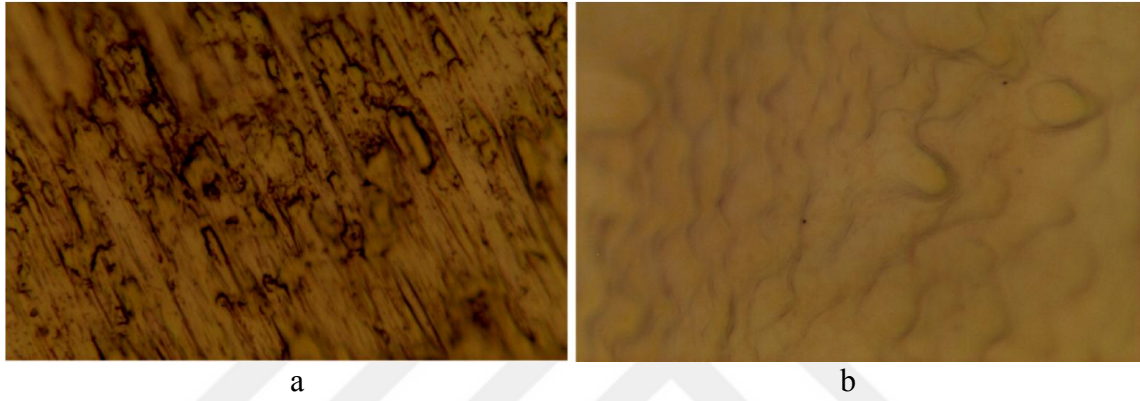
Şekil 3.1. Büyütme işlemi öncesi (a) ve büyütme işlemi sonrası (b) bakır üzerinde gerçekleştirilen grafen sentezine ait optik mikroskop görüntüleri
