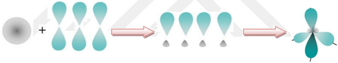
Şekil 2.1. Karbon atomunun sp^3 hibrit gösterimi (Karaduman, 2013)
