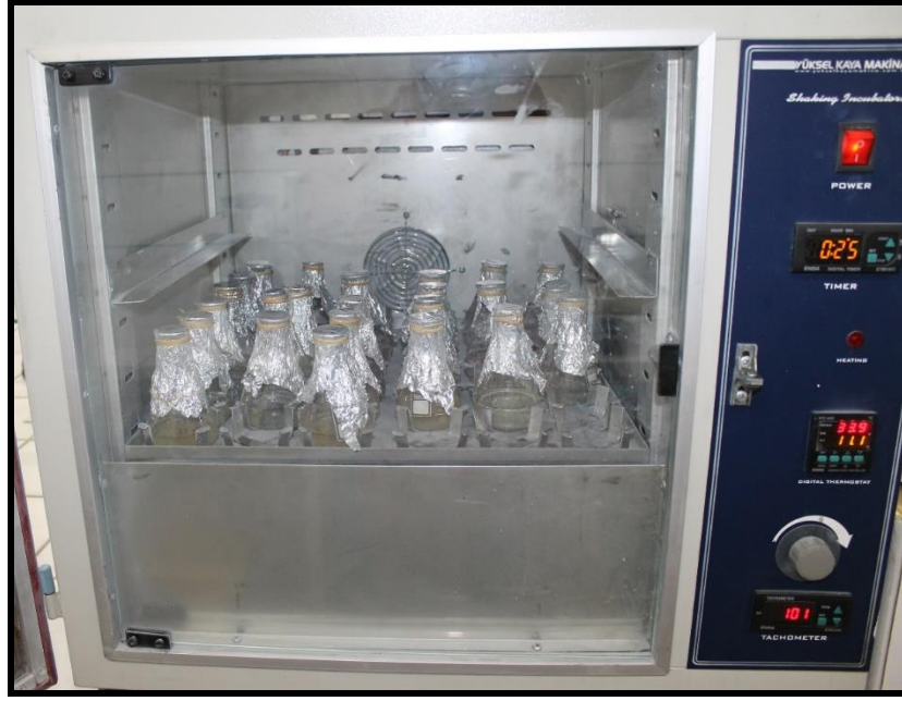
Fotoğraf 3.5. Çalkalayıcı üzerindeki hücre süspansiyon kültürleri
