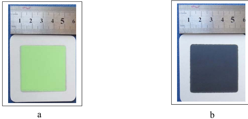
Fotoğraf 2.4. MEG görünümü anot (a) ve katot (b)
