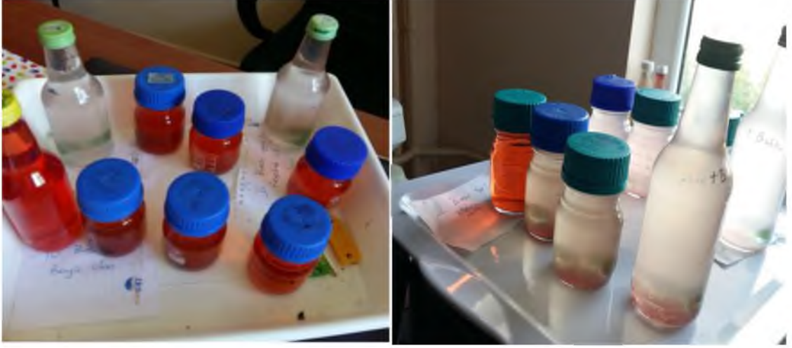
Şekil 3.1. Dekolorizasyon deney düzeneği (a: boya dekolorizasyon ortamının ilk günü, b: boya dekolorizasyon ortamının son günü)
