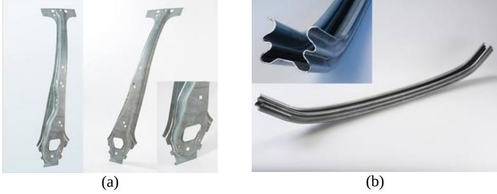
Fotoğraf 1.9. (a) 1,2 mm kalınlığında galvanizlenmiş TRIP780 çelikten üretilmiş takviye ayağı, (b) 1,6 mm kalınlığında galvanizlenmiş TRIP780 çelikten üretilmiş tampon travers ( http://www.arcelormittal.com/automotive , 2014)
