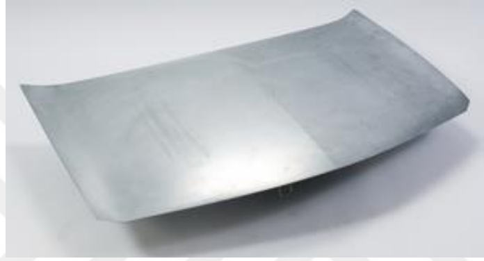
Fotoğraf 1.1. 0,7 mm kalınlığında IF220 çeliğinden üretilmiş motor kaputu ( http://www.arcelormittal.com/automotive , 2014)
