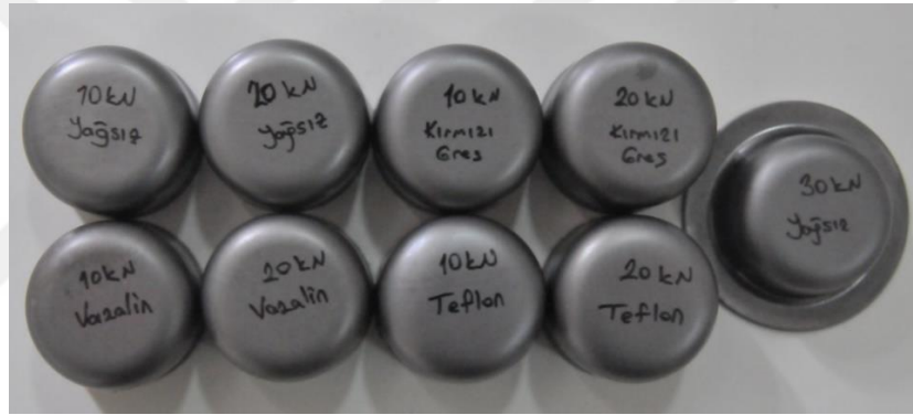
Fotoğraf 3.10. Farklı deney şartlarında derin çekilmiş kaplar
