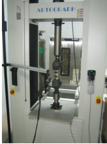
Fotoğraf 3.3. Shimadzu Autograph 100 kN kapasiteli mekanik çekme cihazı
