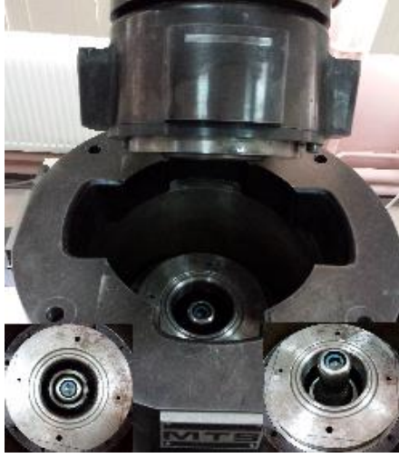
Fotoğraf 3.5. (a) MTS model şekillendirme cihazı, (b) Şekillendirilmiş malzeme
