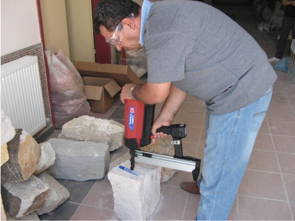
Fotoğraf 3.12: Çivi Penetrasyon Deneyinin blok örnekler üzerinde uygulanması
