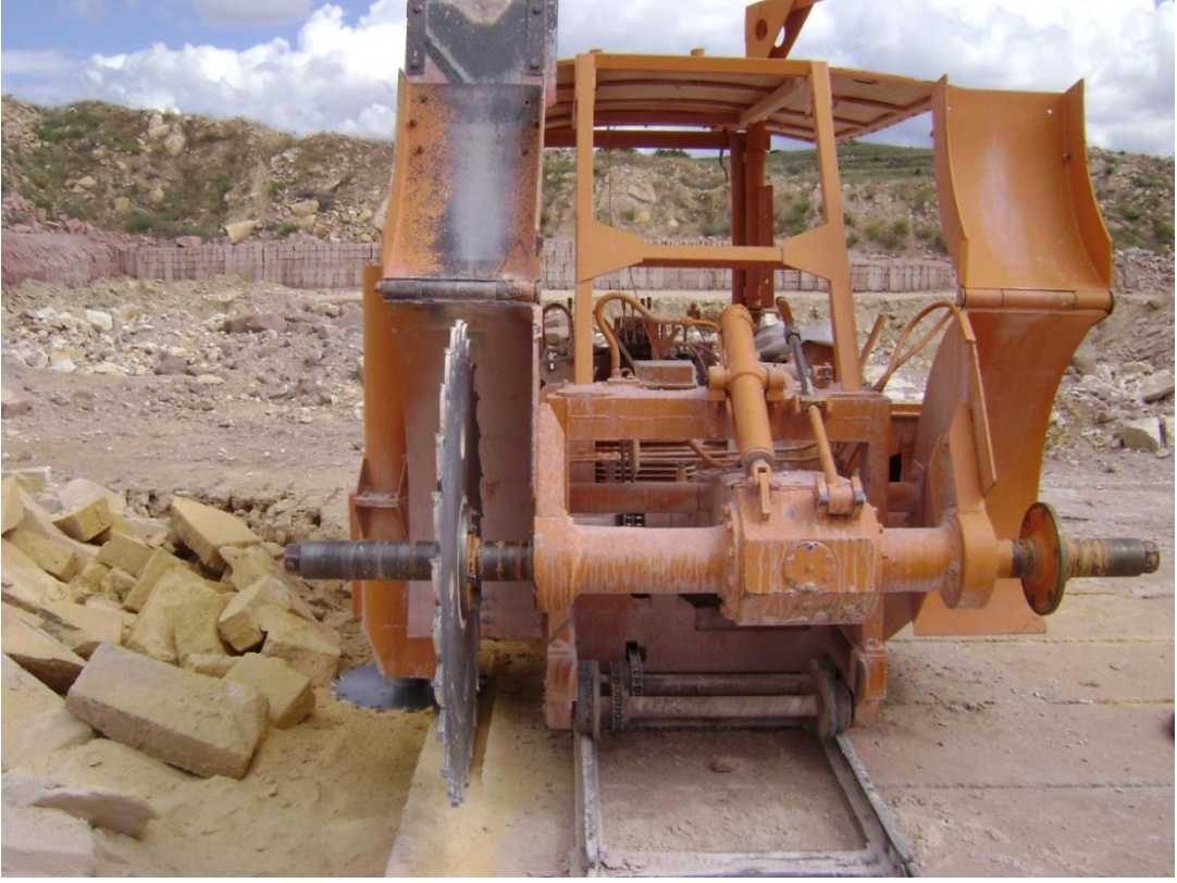
Fotoğraf 3.10. Nevşehir yöresi ocaklarında makineli kesimle taş çıkarılmasından görünüm
