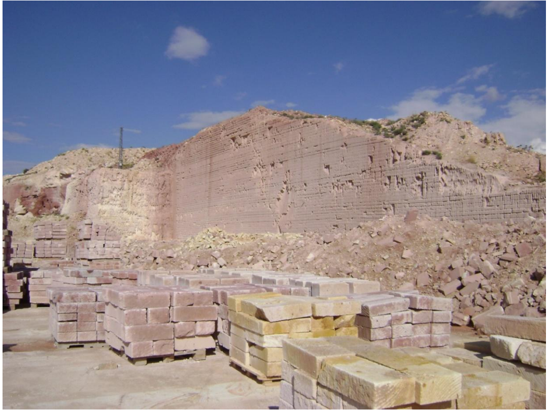
Fotoğraf 3.11. Nevşehir yöresi ocaklarında makine ile düzgün kesilen taşlardan görünüm
