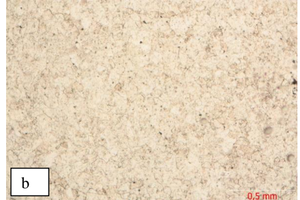
Fotoğraf 3.6. İncekesit 6, NA-1) a: +N, b: // N , Narköy Acıgöl traverteni , mozayik dokulu kalsit kristalleri.
