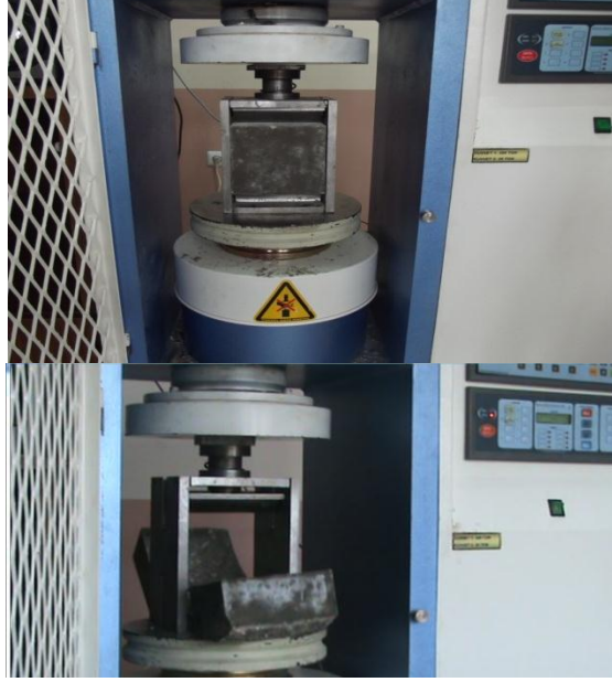
Fotoğraf 3.8. Yarmada çekme dayanımı deneyinin yapılışı
