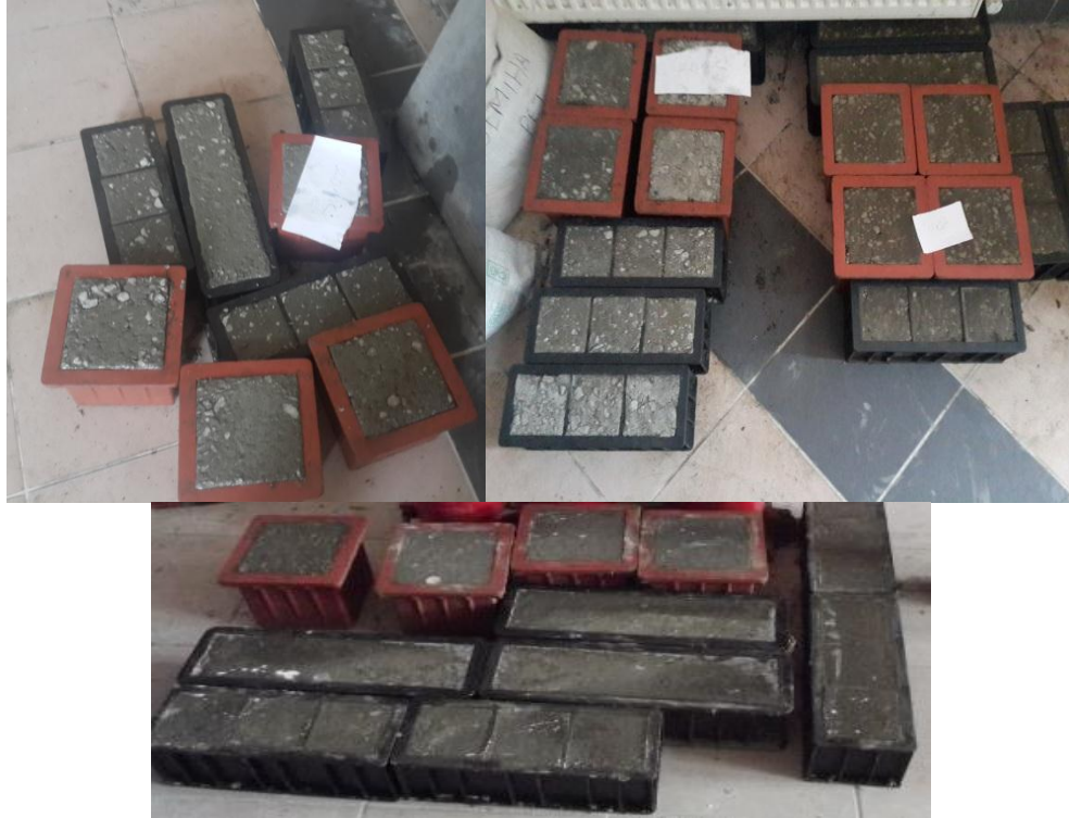
Fotoğraf 3.3. Taze betonun kalıplara yerleştirilmiş görünümü
