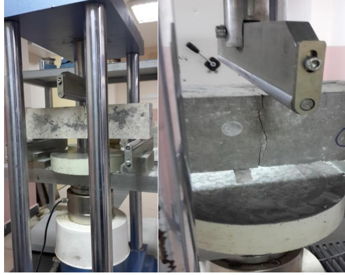
Fotoğraf 3.9. Eğilme dayanımı deneyinin yapılışı
