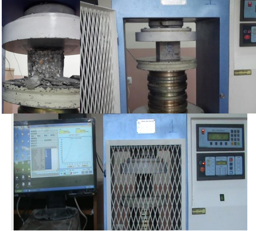
Fotoğraf 3.7. Basınç dayanımı deneyinin yapılışı
