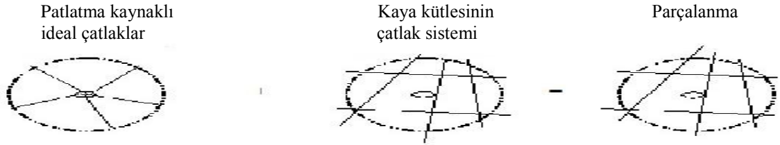
Şekil 7.1 Çatlaklı yapının parçalanma üzerine etkisi [48]
