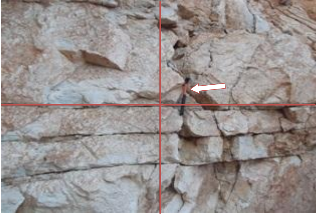
Şekil 7.2 Ayna görüntüsünden hat etüdü ölçümü
