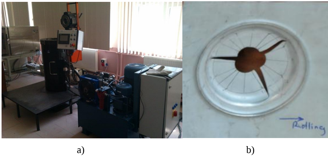
Fotoğraf 3.10. a) Delik genişletme deney düzeneği, b) deformasyona uğratılmış numune
