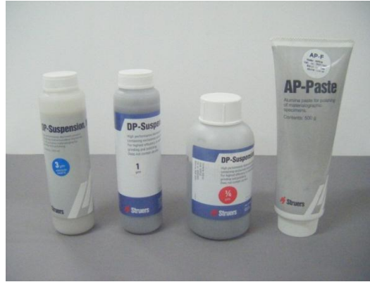
Fotoğraf 3.4. Parlatmada kullanılan elmas süspansiyonlar
