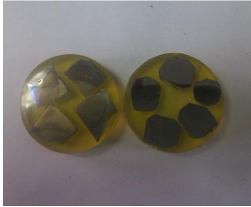
Fotoğraf 3.1. Epoksi-resin ile kalıplanan numuneler
