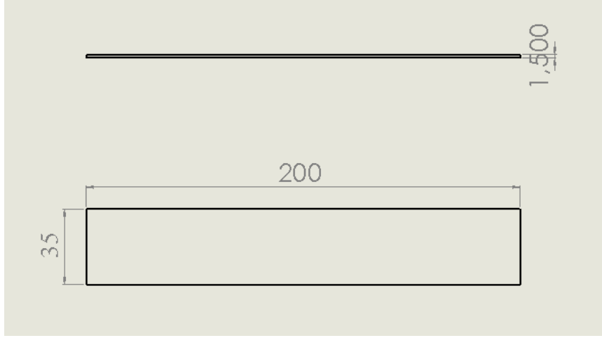
Şekil 3.35. V-eğme için hazırlanmış deney numunesi ölçüleri
