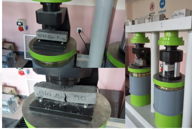
Fotoğraf 3.7. Numuneler üzerinde eğilme deneyi gerçekleştirilmesi
