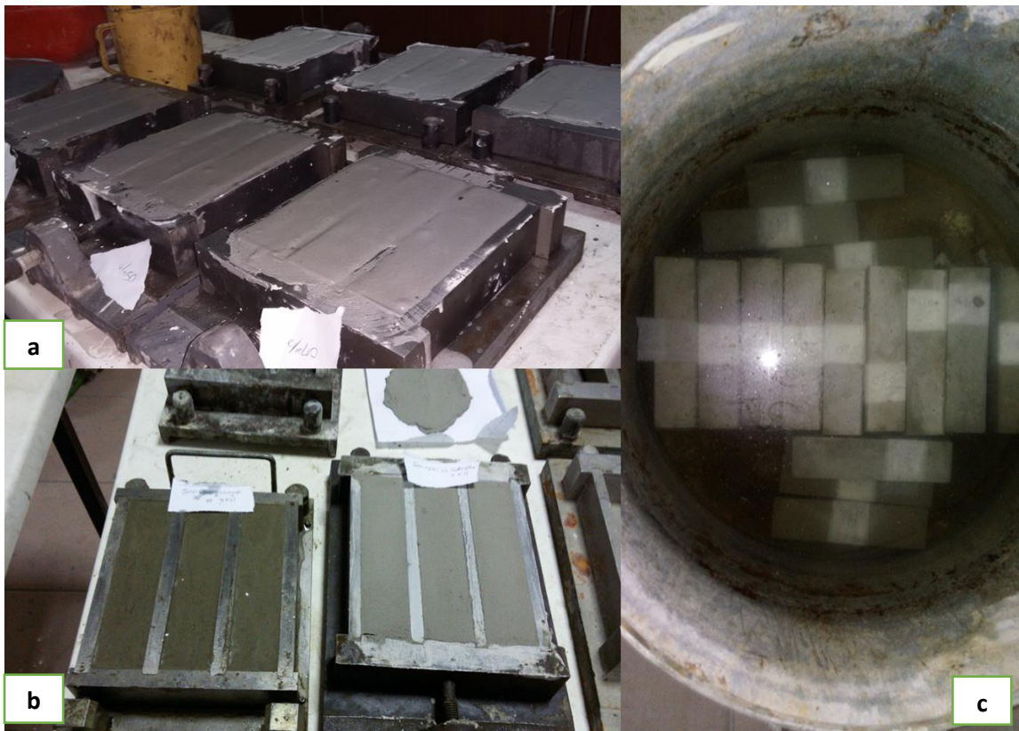
Fotoėraf 3.2. AK ve imentolu  r nlerin kalıplarda sıkıştırılması (a), kalıplarda bekletilmesi (b), su tankında bekletilmesi (c)
