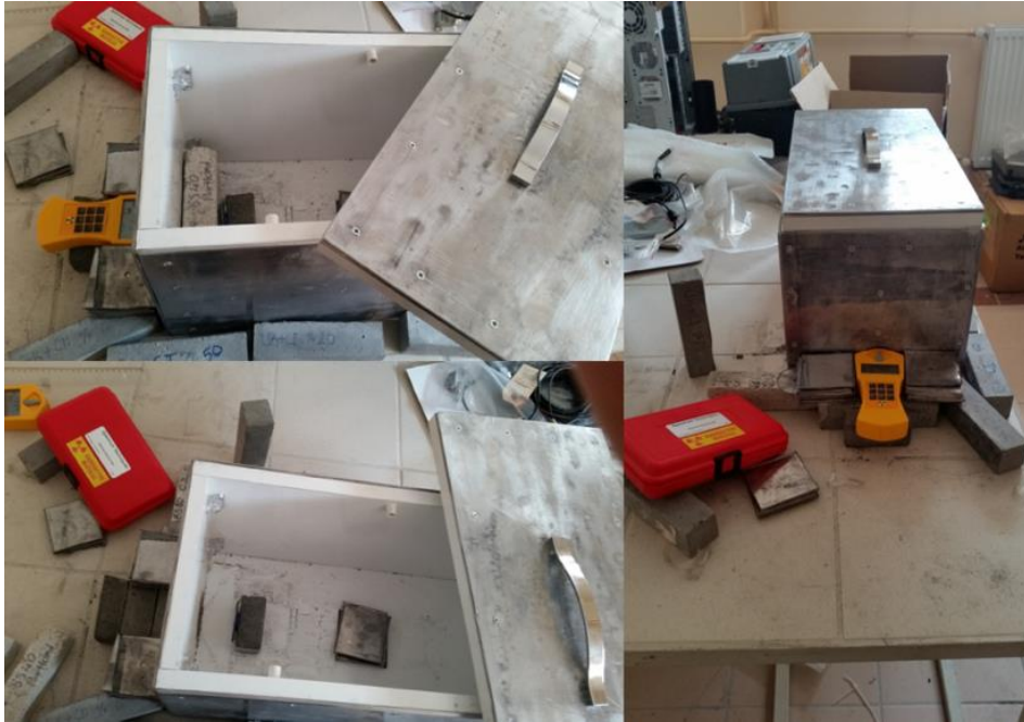
Fotoğraf 3.9. Tezde üretilen yapı panellerinin radyasyon sönümlleme durumunun belirlenmesinde kullanılan kurşun levha ile kaplanmış kafes/kutu, radyasyon kaynağı ve Geiger-Müller sayacı
