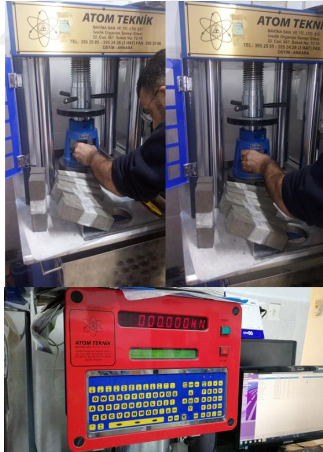
Fotoğraf 3.6. Basınç dayanım testi için kullanılan cihaz
