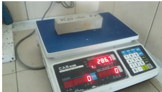
Fotoğraf 3.8. Etüv sonrası kuru BHA tartılması
