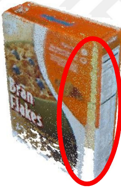
Şekil 2.12. 3B nesne yeniden oluşturma birleştirme hatası
