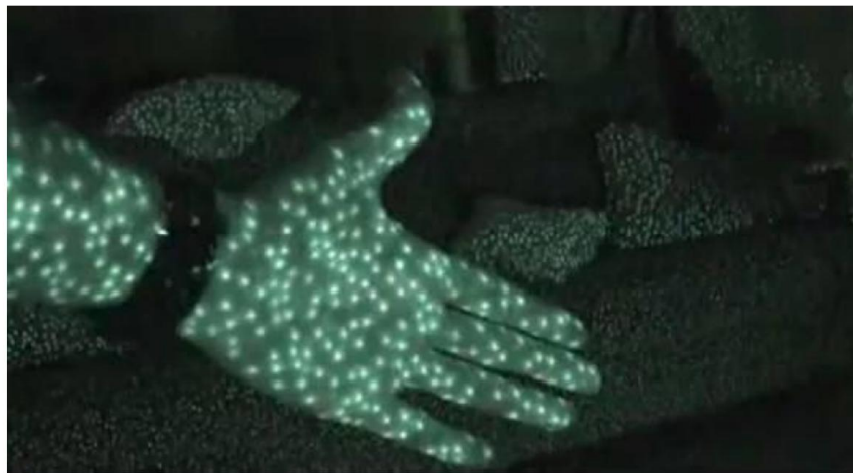
Şekil 2.7. Kinect kızılötesi ışık yapısı
