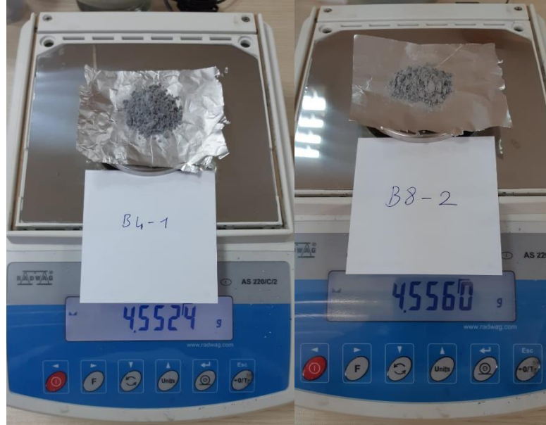
Fotoğraf 3.2. Belirlenen toz miktarlarına göre tartılıp hazırlanan B4 ve B8 numunelerinin toz karışımları
