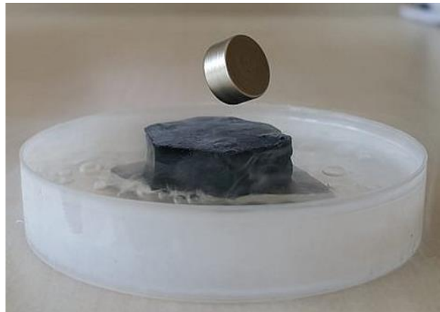
Fotoğraf 3.12. Sıvı azot ile soğutulmuş haldeki HTS'nin kalıcı mıknatısa uyguladığı manyetik kaldırma kuvveti
