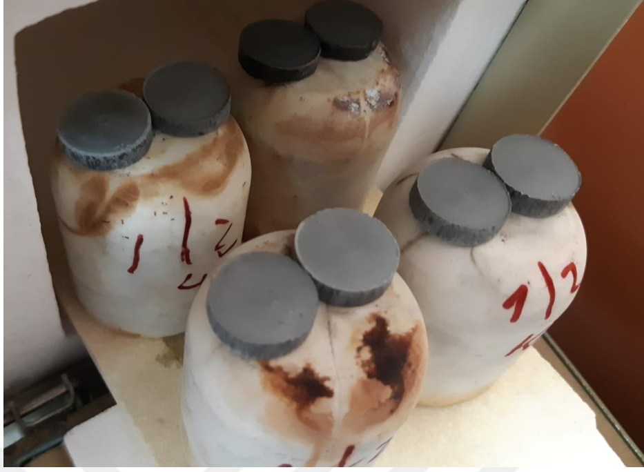
Fotoğraf 3.7. Alümina pota üzerine konularak sinterleme işlemi için hazırlanan numuneler
