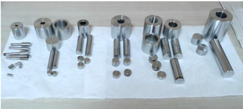
Fotoğraf 3.4. Tablet hazırlamada kullanılan çelik kalıplar
