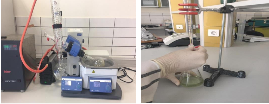
Fotoğraf 3.8. Göğüs eti örneklerinde yağın ekstraksiyonu ve titrasyon işlemi
