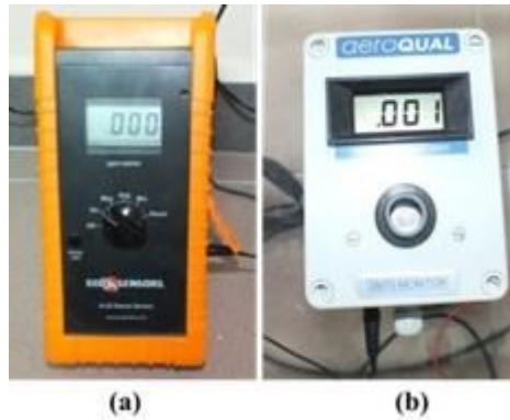
Fotoğraf 3. 8 (a) Rüzgar tüneli test bölgesinin altına yerleştirilen ozon metre, (b) Ölçüm alınan bölgeye yakın yerleştirilen ozon metre (Akansu ve Karakaya, 2013).
