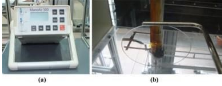
Fotoğraf 3. 7 Dinamik basıncın ölçümünde kullanılan (a) Mikromanometre, (b) Pitot tüpü.
