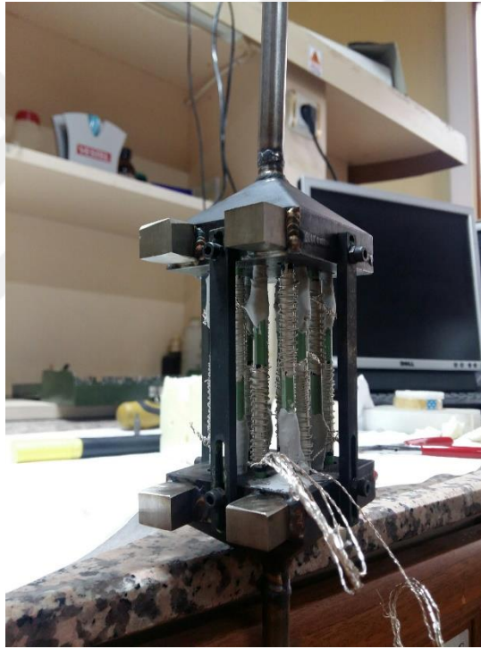
Fotoğraf 4.4. 12 hücreli mikro-tüp stak
