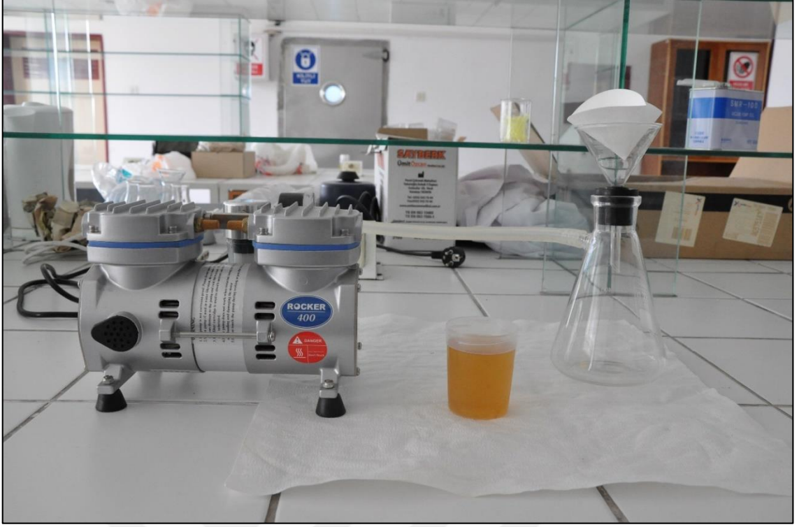
Şekil 3.4. Homojenize edilen örneklerin süzülmesi
