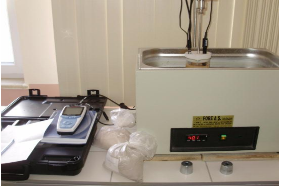
Fotoğraf 3.3. Elektriksel iletkenlik ölçümü deney düzeneğinin görünümü
