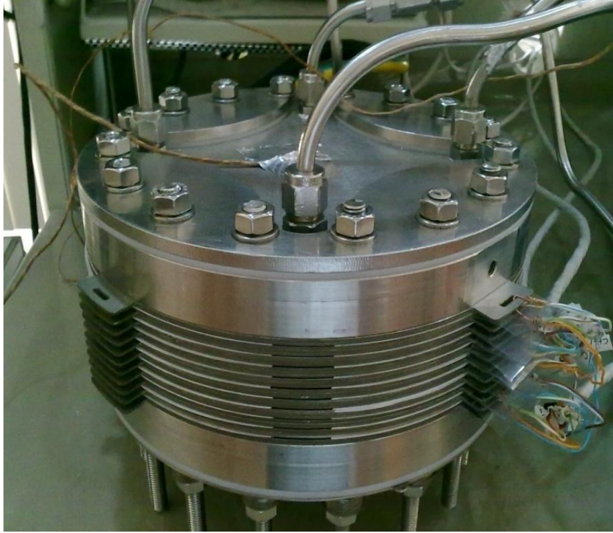
Şekil 5. 11 Stağın herbir hücresinin potansiyelini ölçmek için yapılan bağlantılar
