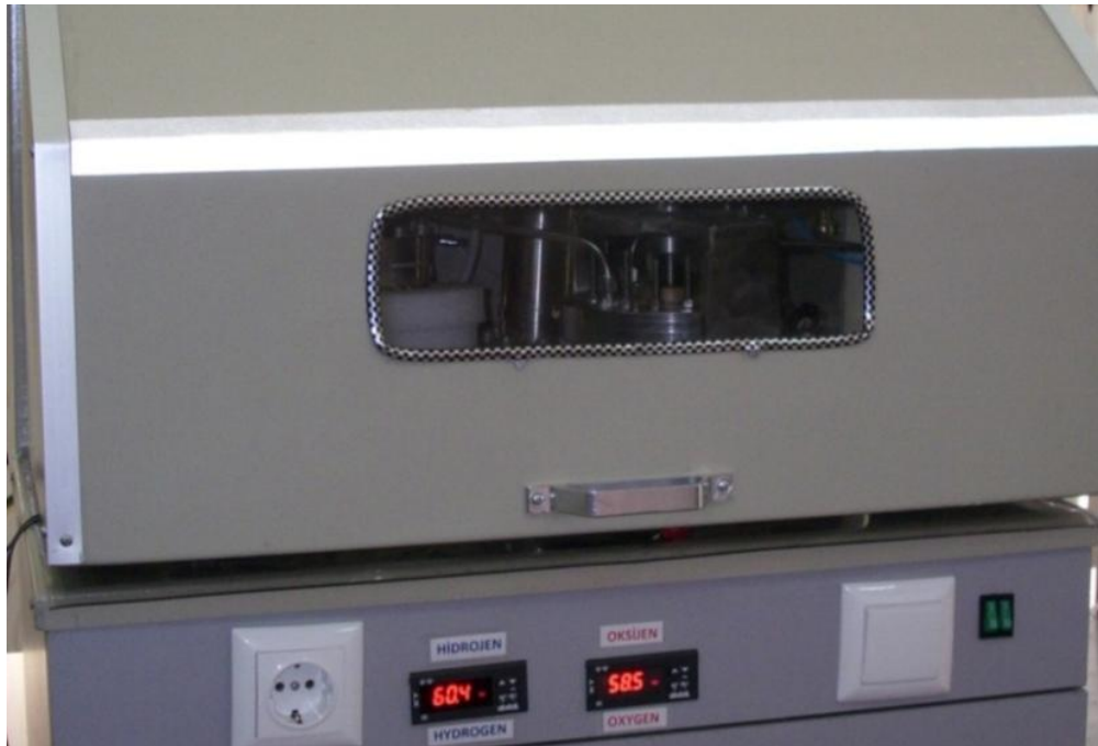
Şekil 5. 5 60 bar hidrojen basıncında çalışan PEM elektrolizör stağı
