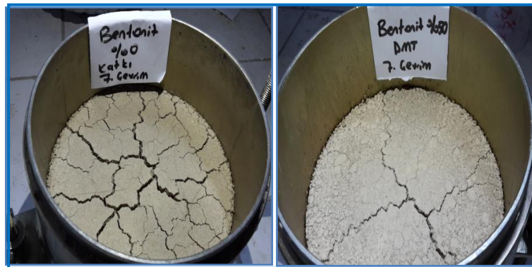
Fotoğraf 5.14. Çevrim sonrası Bentonit kilinde meydana gelen çatlaklar
