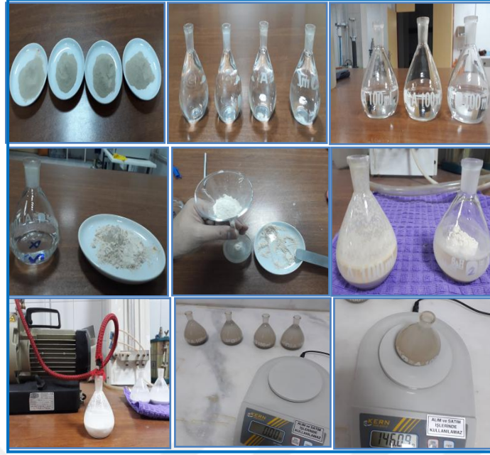
Fotoğraf 5.1. Piknometre deney aşamaları
