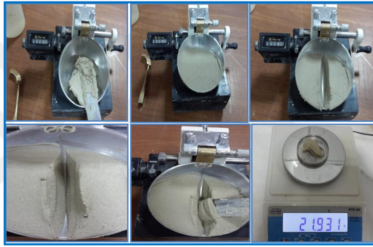
Fotoğraf 5.4. Casagrande deney aşamaları
