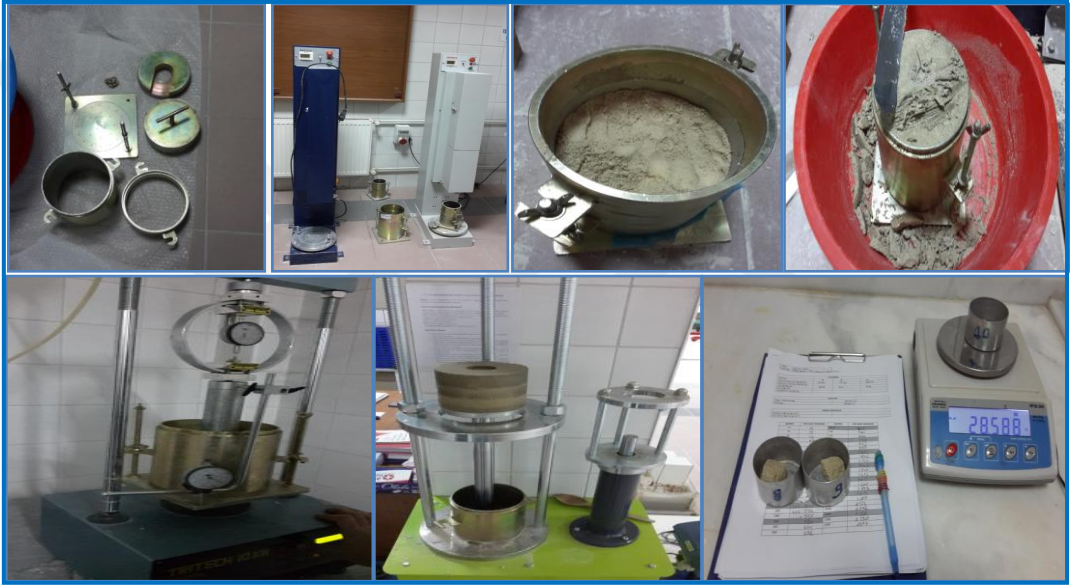
Fotoğraf 5.9. CBR deneyi yapım aşamaları
