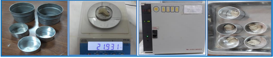
Fotoğraf 5.2. Su muhtevası deney aşamaları
