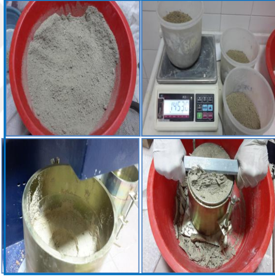
Fotoğraf 5.7. Standart proktor deney numunesi hazırlama
