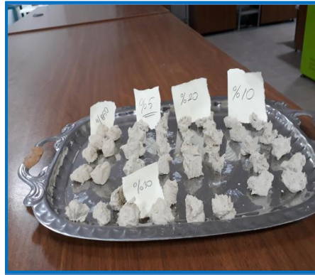
Fotoğraf 5.5. Plastik limit deneyi için alınan numune parçaları
