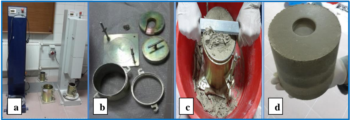
Fotoęraf 5.11. Otomatik numune sıkıřtırıcı (a), CBR kalıp seti (b), Numune hazırlama iřlemi (c) ve Deney sonrası numune grnm (d)
