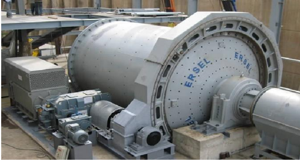
Fotoğraf 4.3. Endüstriyel ölçekli bilyeli değirmen (www.ersel.com).
