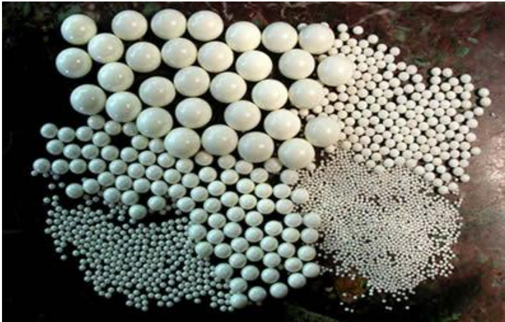
Fotoğraf 5.2. Dik karıştırmalı bilyeli değirmende kullanılan bilyelerin genel görünüşü
