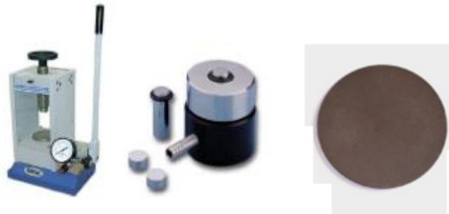
Fotoğraf 3.3 C60 katkılı MgB_2 tablet numune
