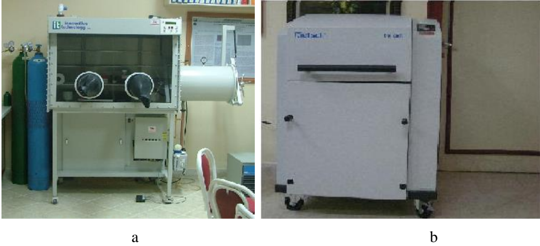
Fotoğraf 3.1 Homojen Toz Hazırlamak için Ar Atmosferli Glove-Box (a) ve Ball Milling (b)
