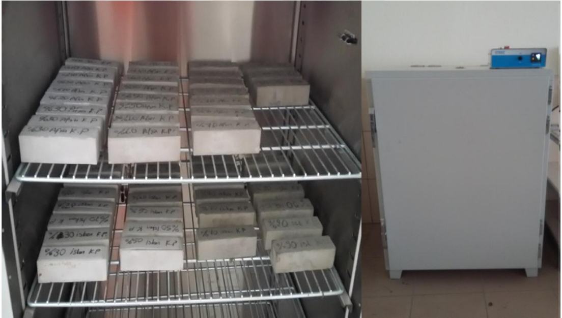
Fotoğraf 3.4. Etüvde kurutulan yapı panelleri
