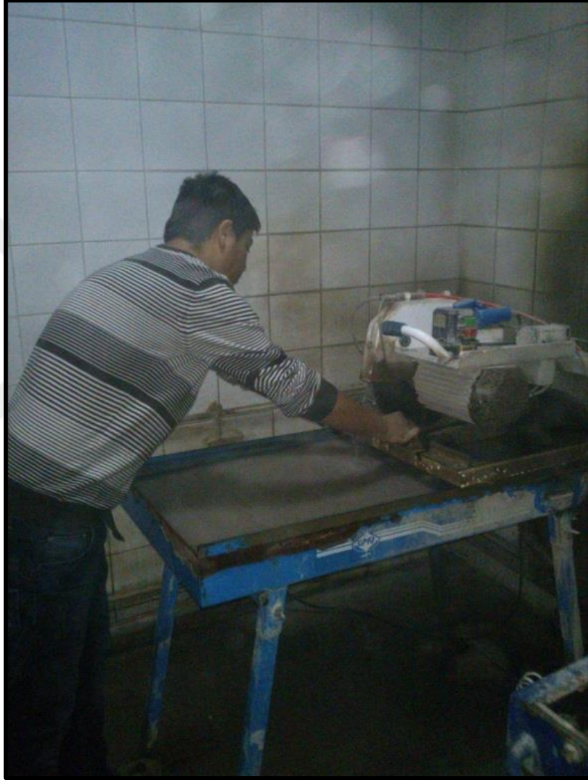
Fotoğraf 3.1. Arazide alınan örnek numunelerin kayaç kesme laboratuvarında boyutlandırma işlemi
