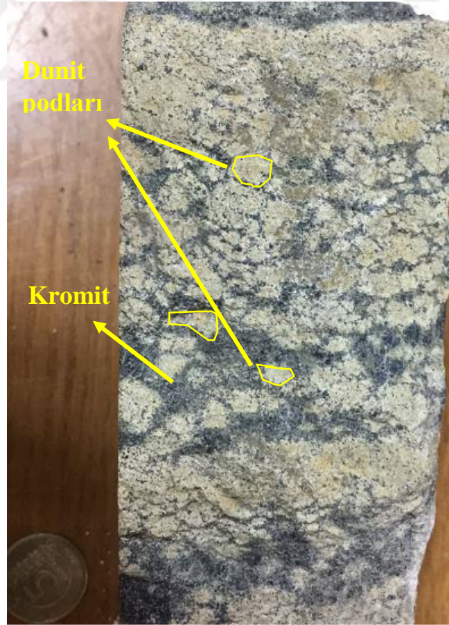
Fotoğraf 6.12. Çalışma alanında gözlenen bantlı kromit cevher örneği
