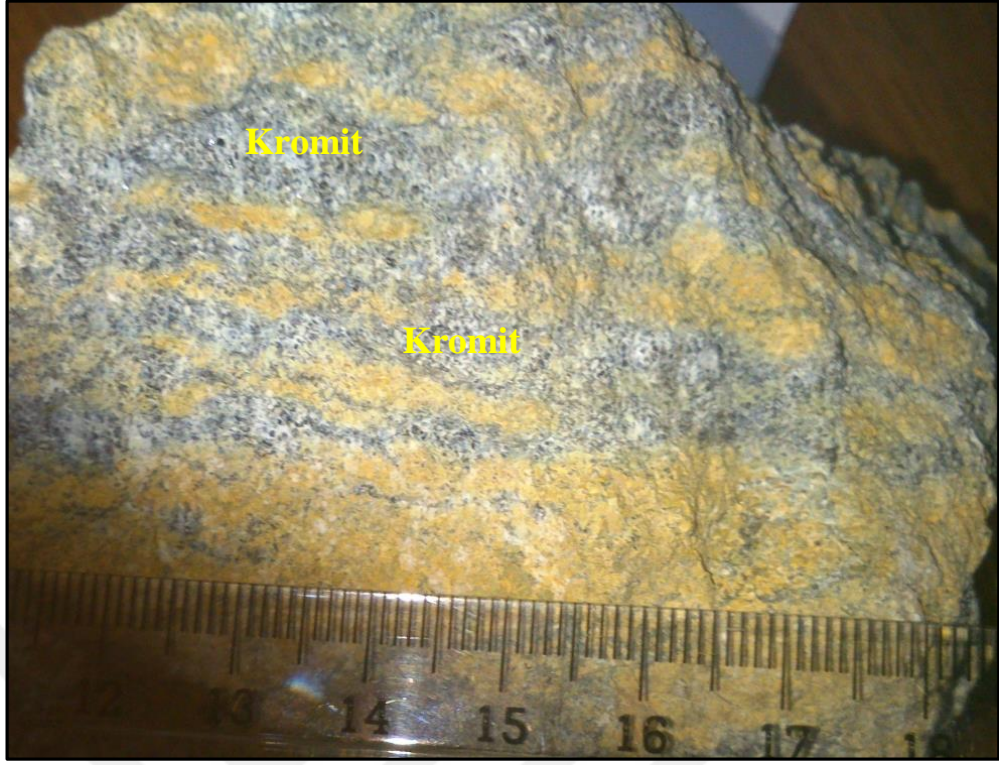
Fotoğraf 6.11. Çalışma alanında gözlenen bantlı kromit cevher örneği
