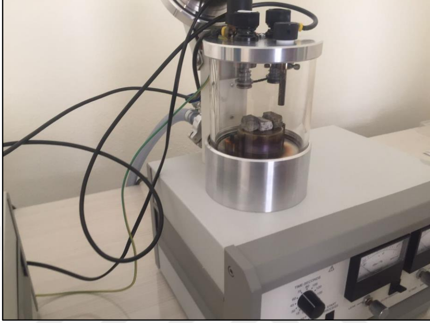
Fotoğraf 3.3. Hazırlanan numunelerin Niğde Ömer Halisdemir Üniversitesi araştırma laboratuvarında karbon (C) ile kaplaması
