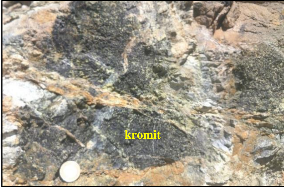
Fotoğraf 6.8. Çalışma alanındaki masif kromit cevher örneği
