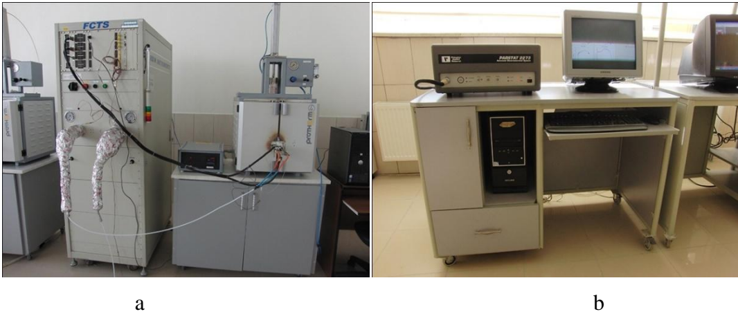
Fotoğraf 3.6. Laboratuvarında kullanılan yakıt pili test istasyonu (a) ve empedans ölçüm cihazı (b)
